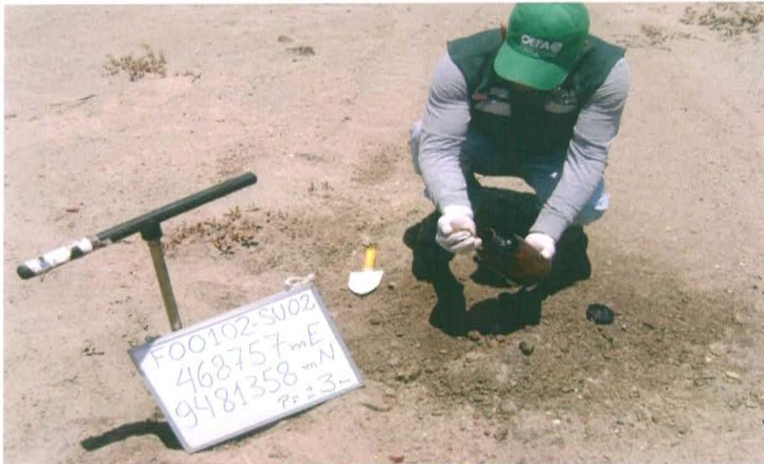
Fotografía N° 4. Toma de muestra de suelo en el punto F00102-SU02, a 8 m al este del pozo y a una profundidad de 0,7 m a 0,8 m.
