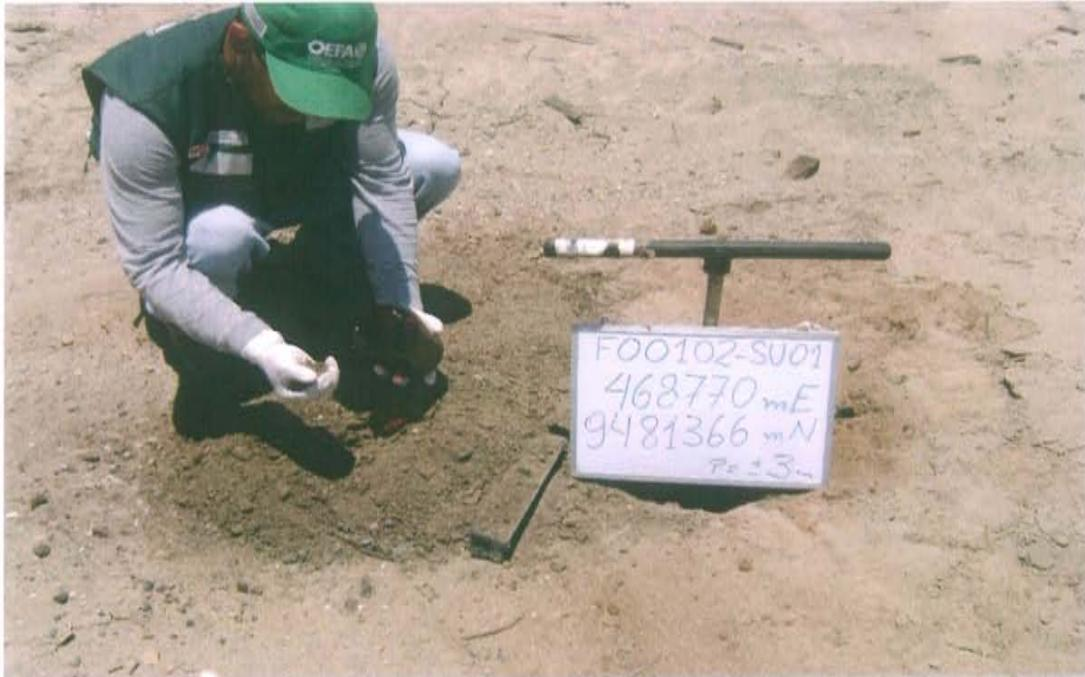
Fotografía N° 3. Toma de muestra de suelo en el punto F00102-SU01, a 9 m al norte del pozo y a una profundidad de 0,85 m a 0,95 m.
