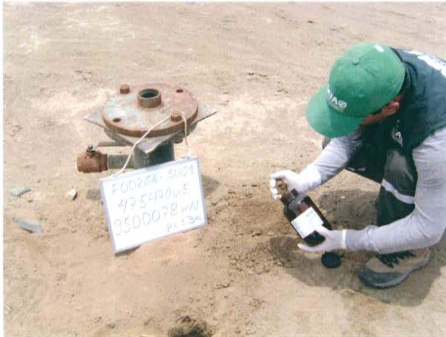
Fotografía N° 3. Toma de muestra de suelo en el punto F00266-SU01, ubicado a 1,0 m aproximadamente del pozo T3279.
