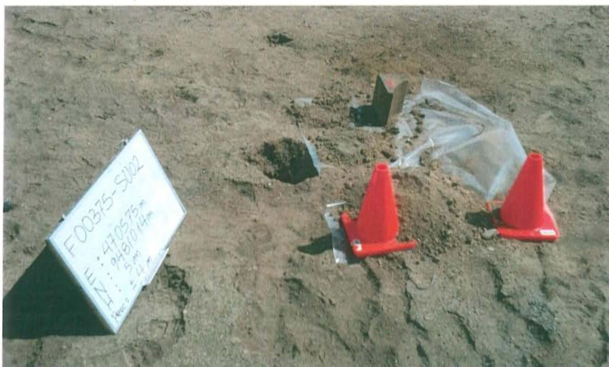
Fotografía N° 4. Punto de muestreo de suelo F00375-SU02, a 4 m al sur del pozo y a una profundidad de 0,60 m - 0,70 m.
