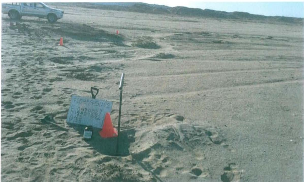
Fotografía N° 4. Punto de muestreo F00359-SU02, aproximadamente a 16 m al este del pozo, capa superficial de 0 m a 0,25 m de arena (erosión eólica).
