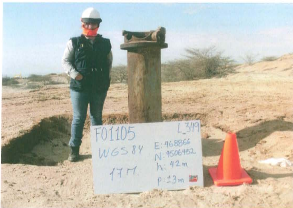
Fotografía N° 2. Se observa el pozo con brida de 15 pulgadas dañada
