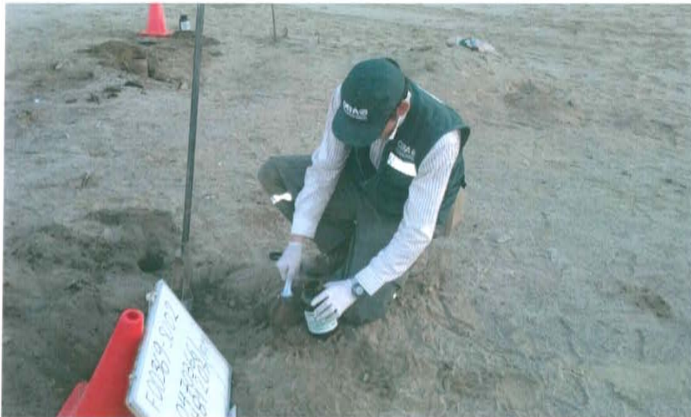
Fotografía N° 4. Puntos de muestreo de suelo a una profundidad de 0,50 m a 0,60 m.
