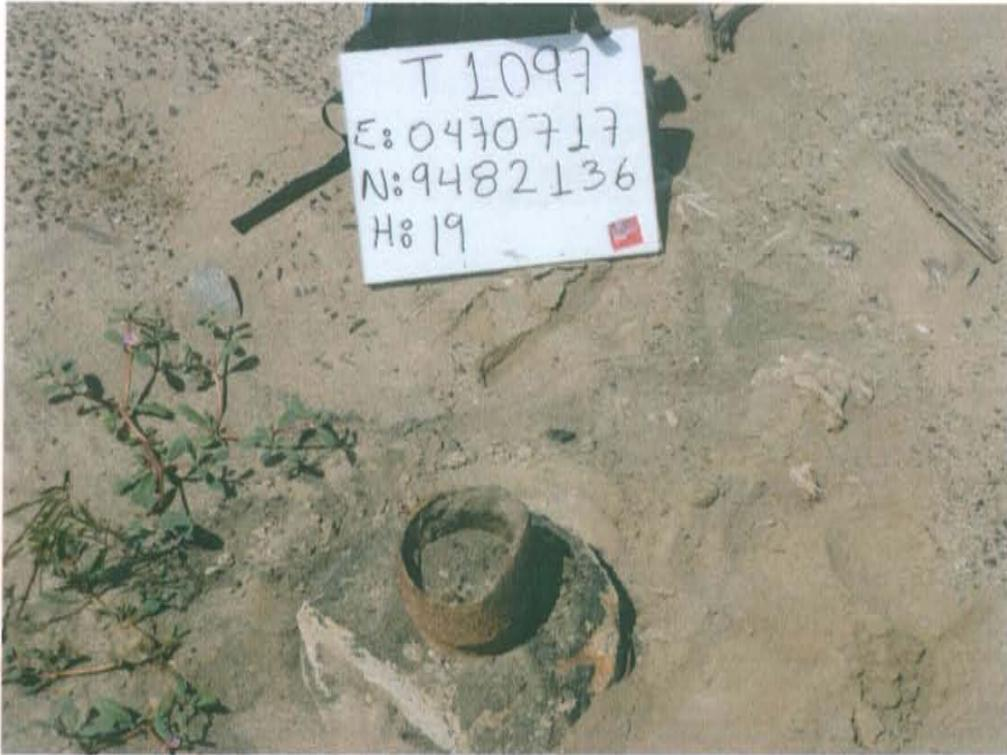
Fotografía N° 1. El Pozo T1097, presenta casing cementado y corroído.
