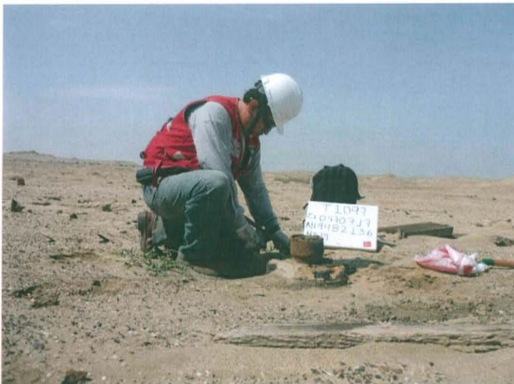
Fotografía N° 4. Toma de muestra de suelo adyacente al Pozo T1097.
