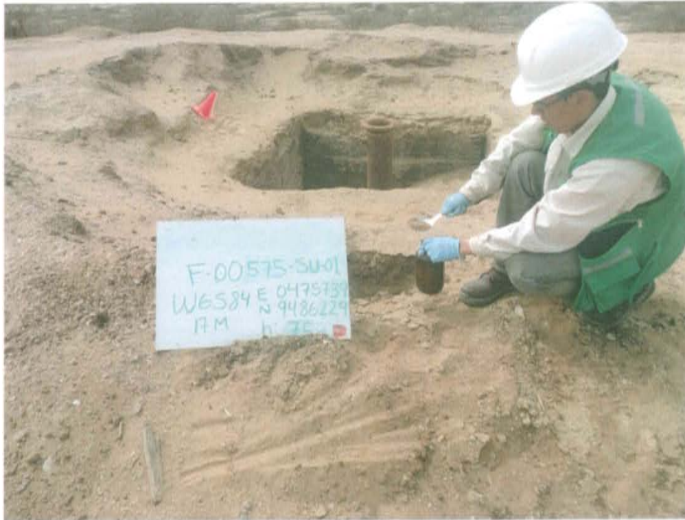
Fotografía N° 3. Toma de muestra de suelo en el punto F00575-SU01, ubicado a 2 m aproximadamente del Pozo T2788.
