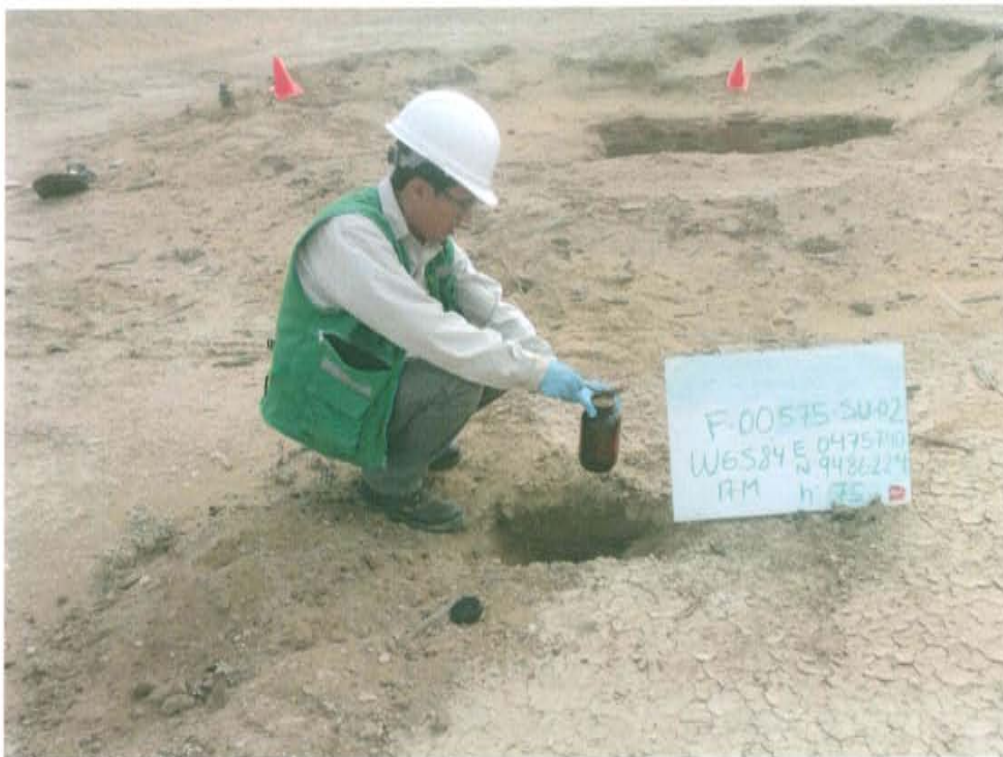
Fotografía N° 4. Toma de muestra de suelo en el punto F00575-SU02, ubicado a 5 m aproximadamente del Pozo T2788
