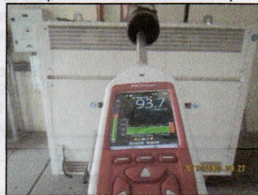
Verificación al final de la primera medición
