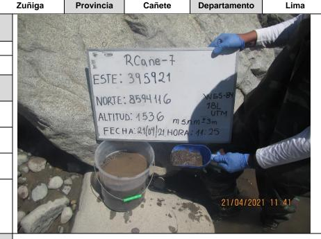
Punto de muestreo ubicado en la margen derecha del río Cañete, aproximadamente a 250 m aguas abajo del del eje de presa Capillucas
