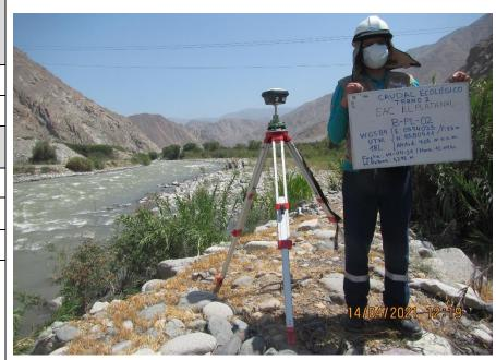
Punto geodésico base, a 150 m aguas arriba del inicio del Tramo de caudal ecológico, al margen derecho del rio Cañete. Medición continua con GPS diferencial.
