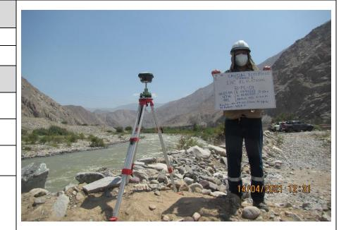
Punto geodésico base, a 50 m aguas abajo del final del Tramo de caudal ecológico, al margen derecho del rio Cañete. Medición continua con GPS diferencial.
