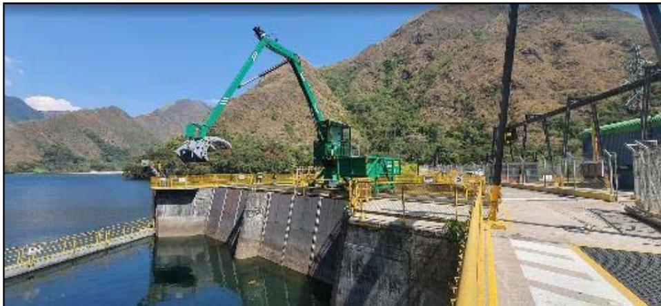
Imagen 4: Vista del robot hidráulico para retirar malezas y tronco.
