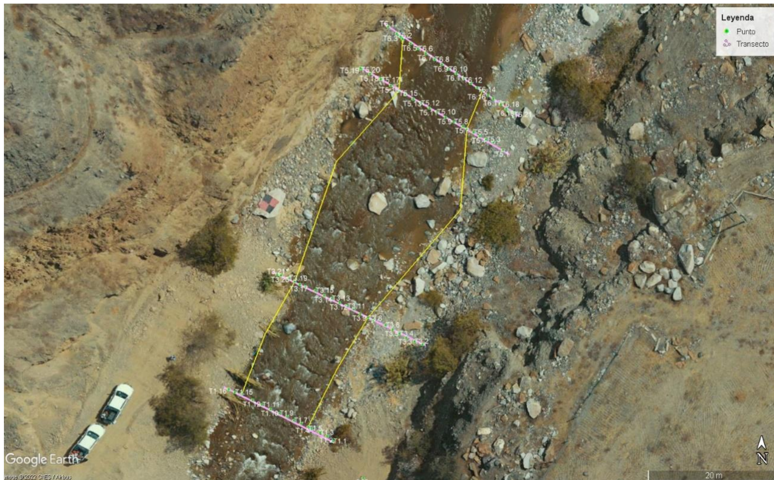
Figura 6.50. Inspección aérea con dron mostrando los puntos y transectos del tramo de río de RHUA-06
