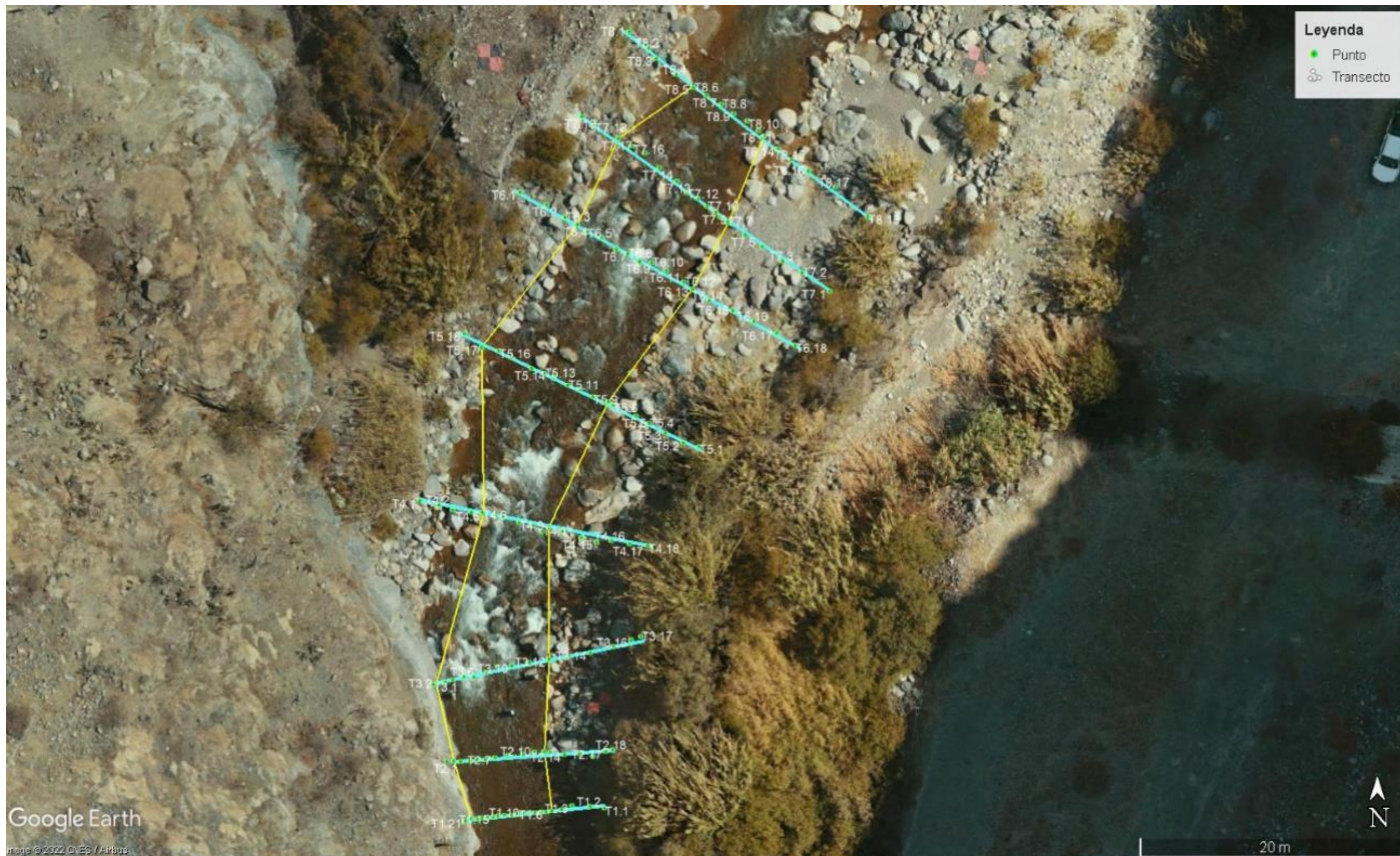
Figura 6.53. Inspección aérea con dron mostrando los puntos y transectos del tramo de río de RHUA-07
