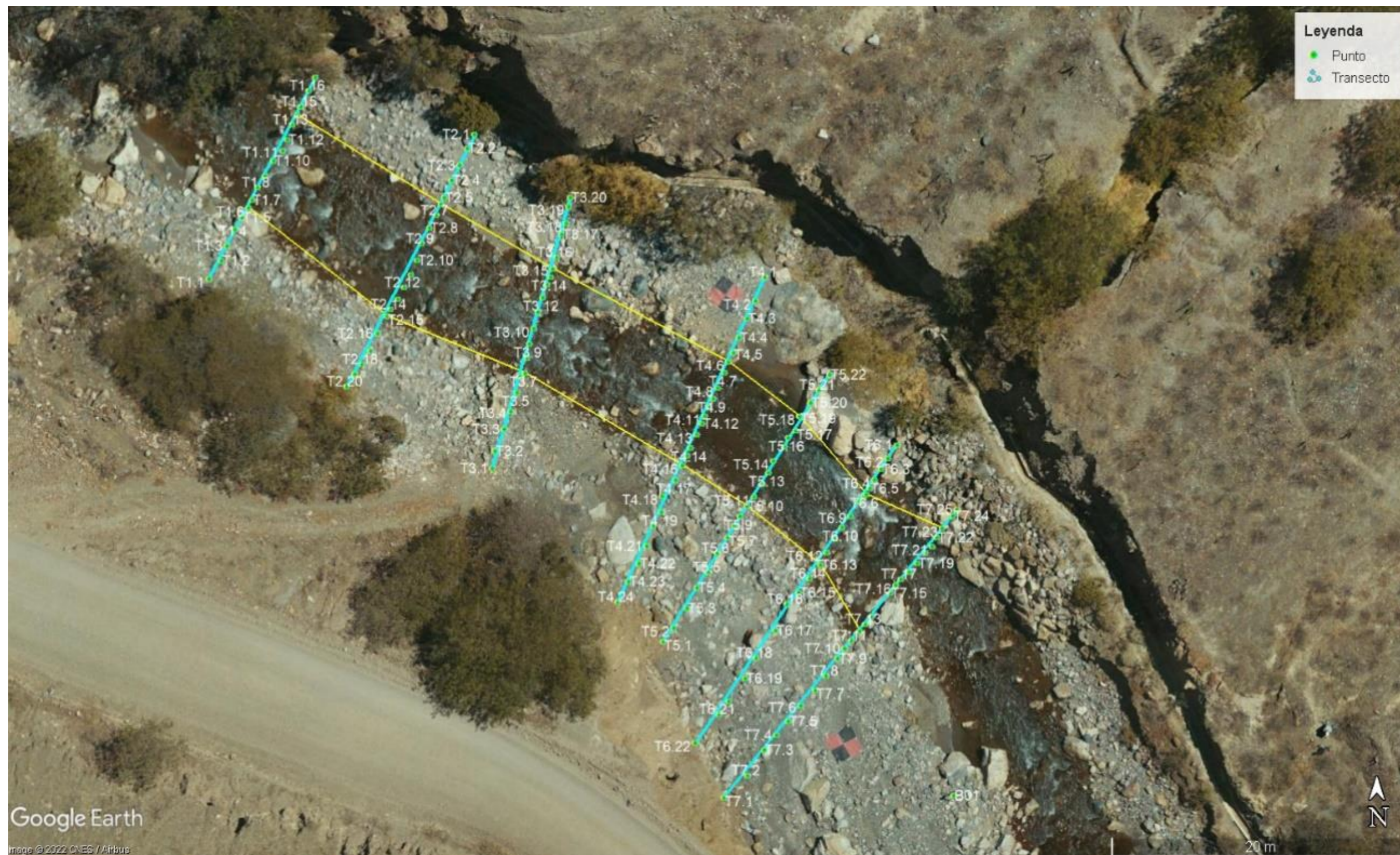
Figura 6.41. Inspección aérea con dron mostrando los puntos y transectos del tramo de río de RCHE-02 (TCE)
