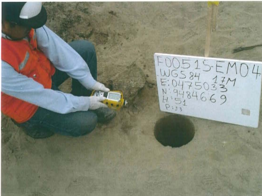
Fotografía N° 4. Medición de emisiones gaseosas fugitivas en el punto F00515-EM04, ubicado en la fuente de emisión en boca del Pozo T1566.
