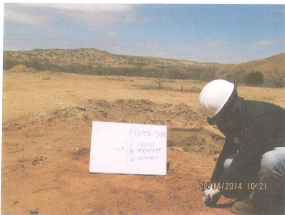
Fotografía N° 3. Toma de muestra de suelo en el punto F00956-SU01, aproximadamente a 2 m del Pozo L9378.
