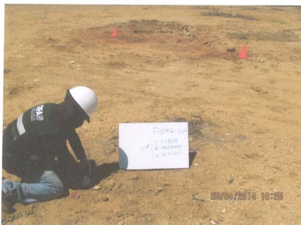
Fotografía N° 4. Toma de muestra de suelo en el punto F00956-SU02, aproximadamente a 9 m del Pozo L9378.
