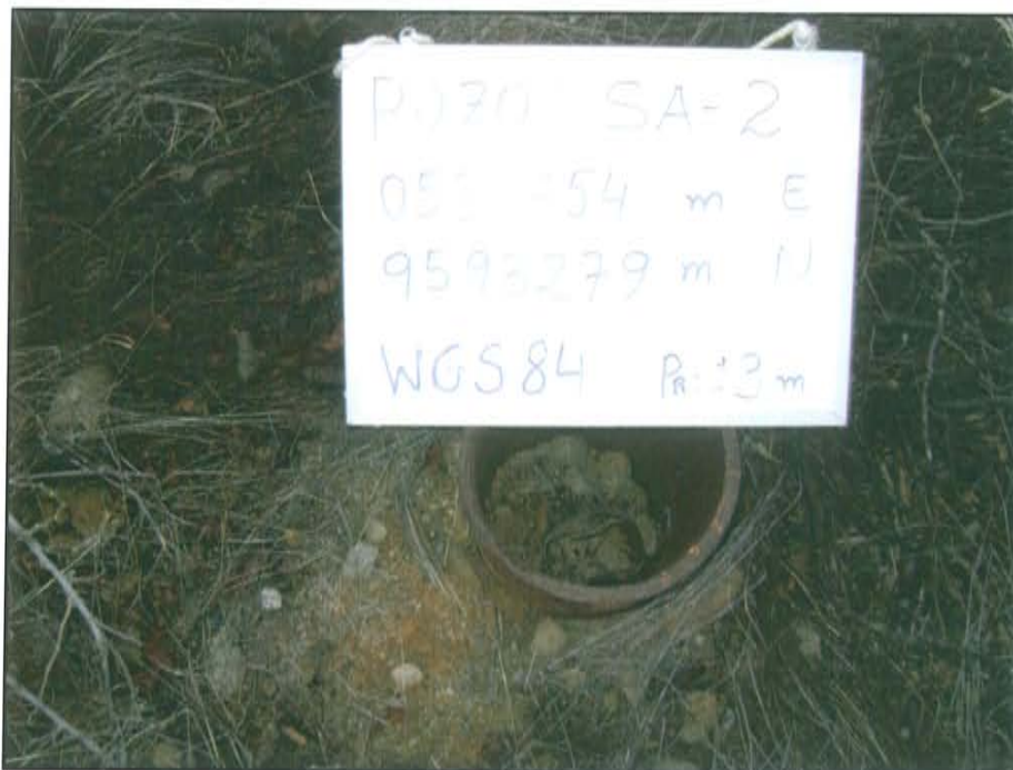
Fotografía N° 1. Pozo inactivo, con casing semi enterrado.
