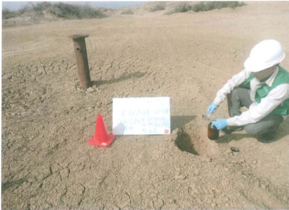
Fotografía N° 3. Punto de muestreo de suelo F00578-SU01 a 2 m del casing y a una profundidad de 0,3 m de la superficie del suelo.
