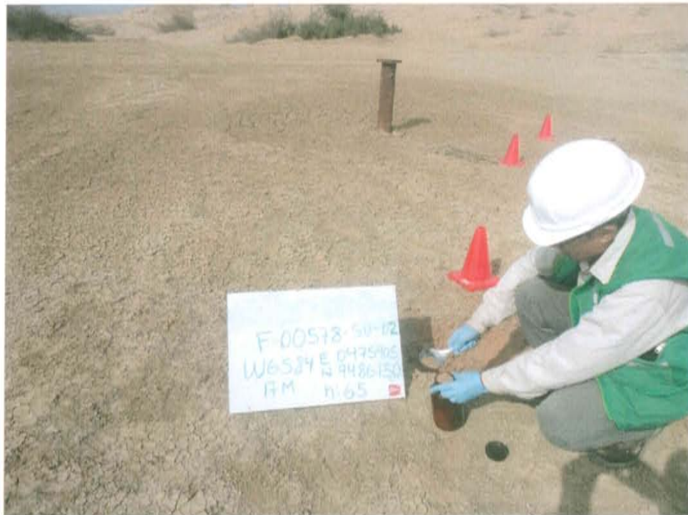
Fotografía N° 4. Punto de muestreo de suelo F00578-SU02 a 5 m del casing y a una profundidad de 0,3 m de la superficie del suelo.
