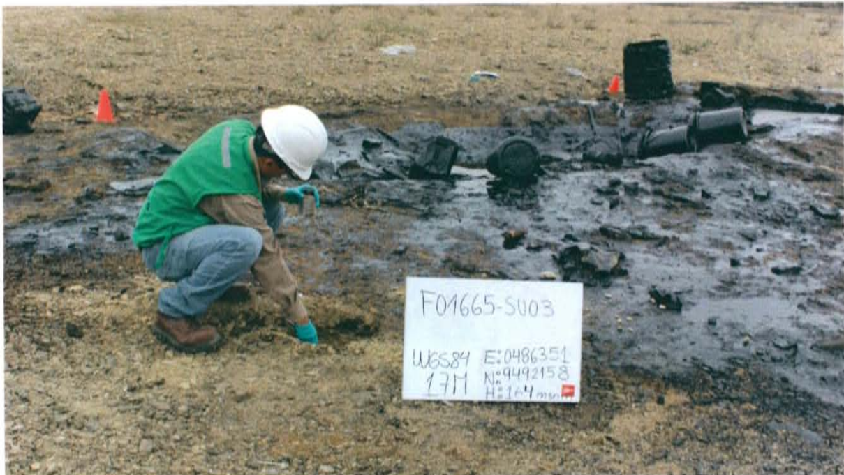
Fotografía N° 8. Toma de muestra de suelo en el punto F01665-SU03, ubicado a 10,2 m en dirección Norte del Pozo T3662.
