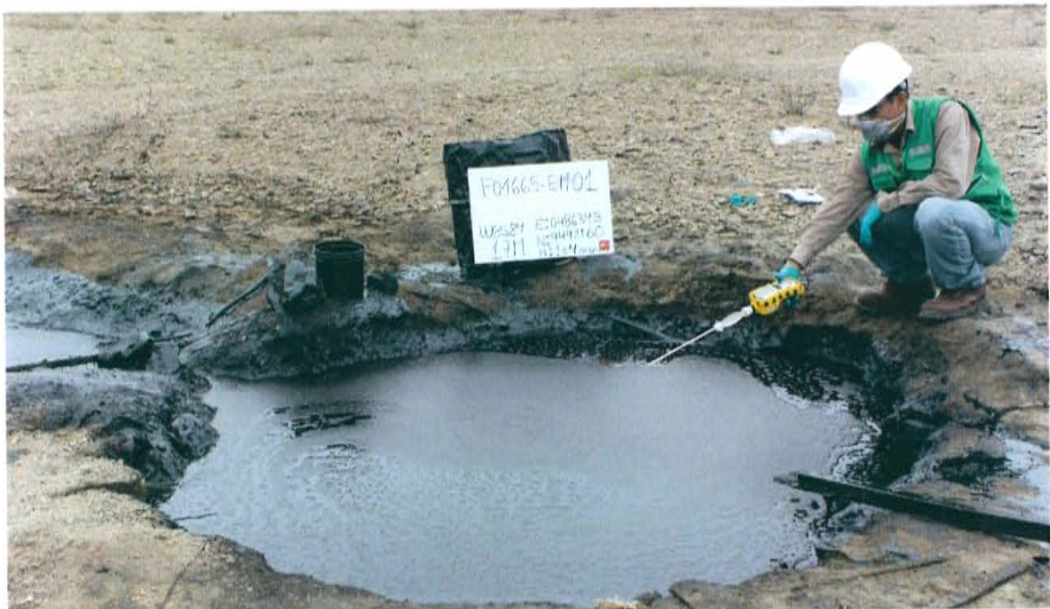
Fotografía N° 4. Monitoreo para detección de presencia de gases asociados a la presencia del pozo en emisiones gaseosas fugitivas en el punto F01665-EM01 (boca de Pozo), ubicado en la fuente de emisión, se puede apreciar el burbujeo en el fluido dentro del hoyo donde se ubica el pozo.
