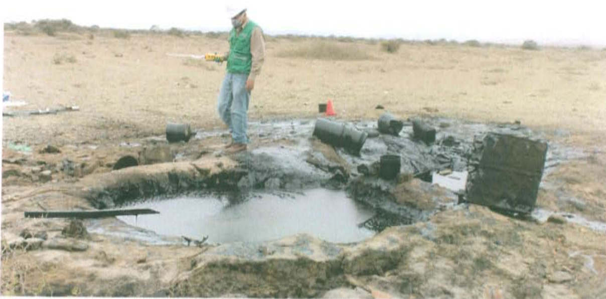
Fotografía N° 5. Monitoreo para detección de presencia de gases asociados a la presencia del pozo en emisiones gaseosas fugitivas en el punto F01665-VA01, se realizó recorrido en le área circundante al pozo T3662 en un radio de 1 m, con una duración de 10 minutos.
