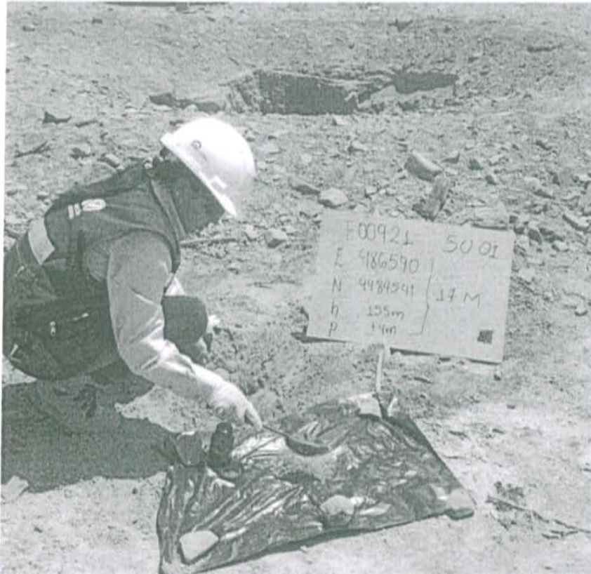
Fotografía N° 1. Toma de muestra en el punto F00921-SU01, ubicado a 3.60 m de distancia del casing del pozo T2030 a una profundidad de 0.25 m de la superficie del suelo.
