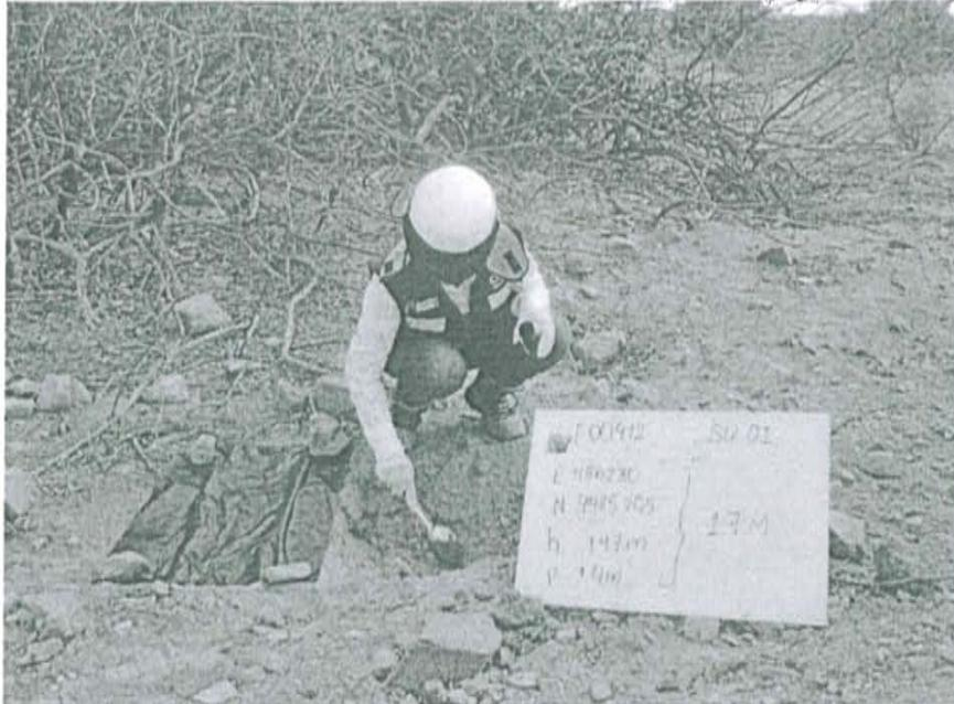
Fotografía N° 1. Toma de muestra en el punto F00912-SU01, ubicado a 3 m de distancia del casing del pozo T2510 a una profundidad de 0.20 m de la superficie del suelo.
