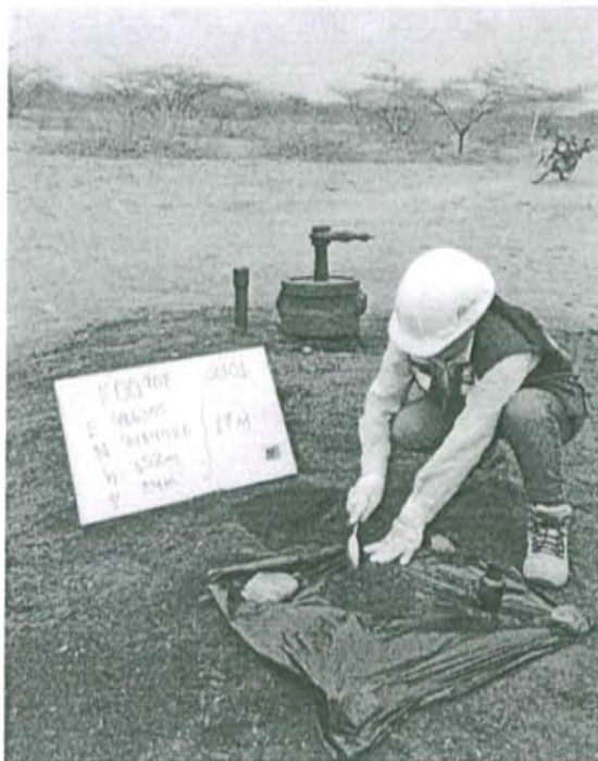
Fotografía N° 1. Toma de muestra en el punto F00907-SU01, ubicado a 2.5 m de distancia del casing del pozo T2335 a una profundidad de 0.15 m de la superficie del suelo.
