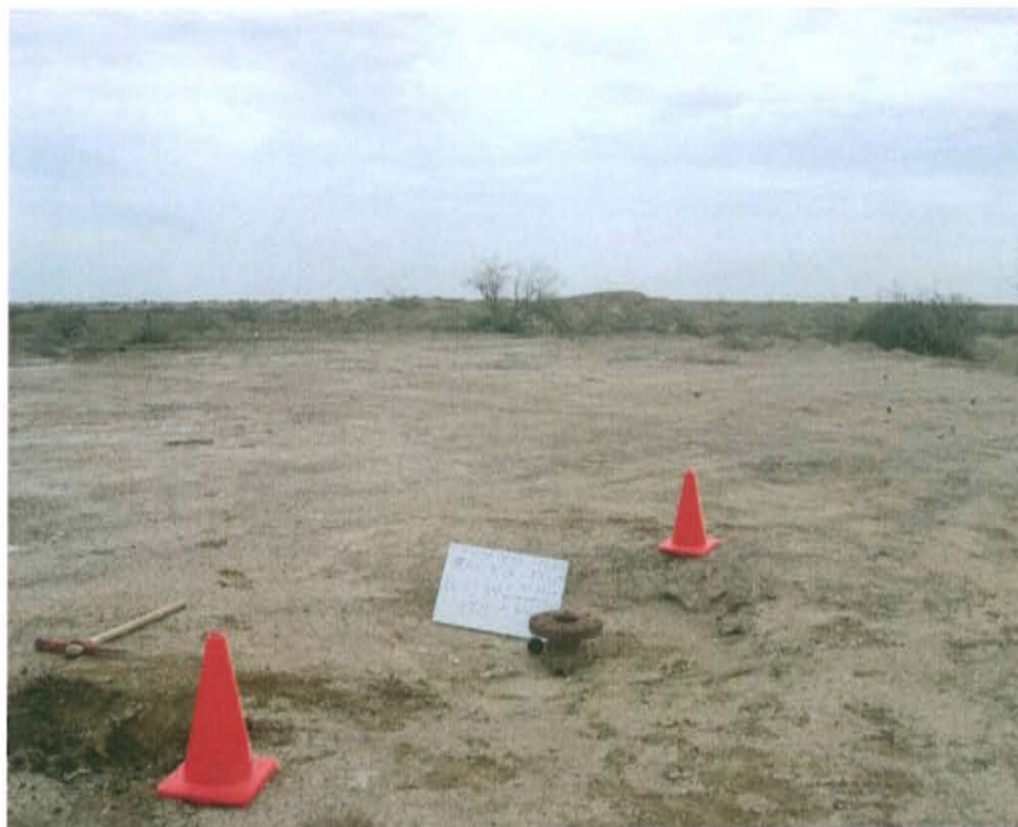
Fotografía N° 2. Vista panorámica del pozo T5364, se observa suelo impregnado con hidrocarburos en el área circundante al pozo.
