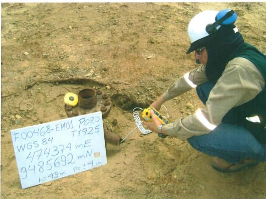
Fotografía N° 4. Medición de emisiones en el punto F00468-EM01, medida en la boca del Pozo T1925.
