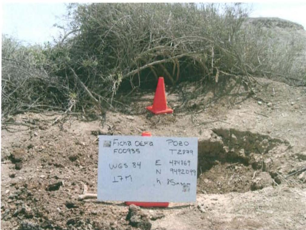
**Fotografía N° 2.** Vista panorámica del pozo T2879, se observa suelo impregnado con hidrocarburos en el área circundante al pozo.
