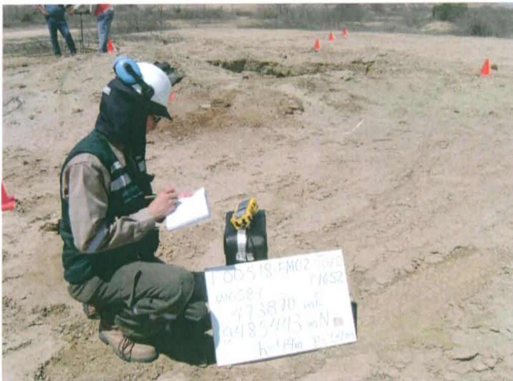
Fotografía N° 4. Medición en el punto F00518-EM02, ubicado a 8 m de distancia de la fuente de emisión a sotavento.
