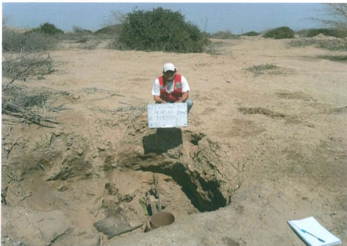
Fotografía N° 1. Pozo con código Ficha OEFA F00559 y código PERUPETRO T1671, se observa el casing abierto dentro de un hoyo de aproximadamente 1,6 m de profundidad.
