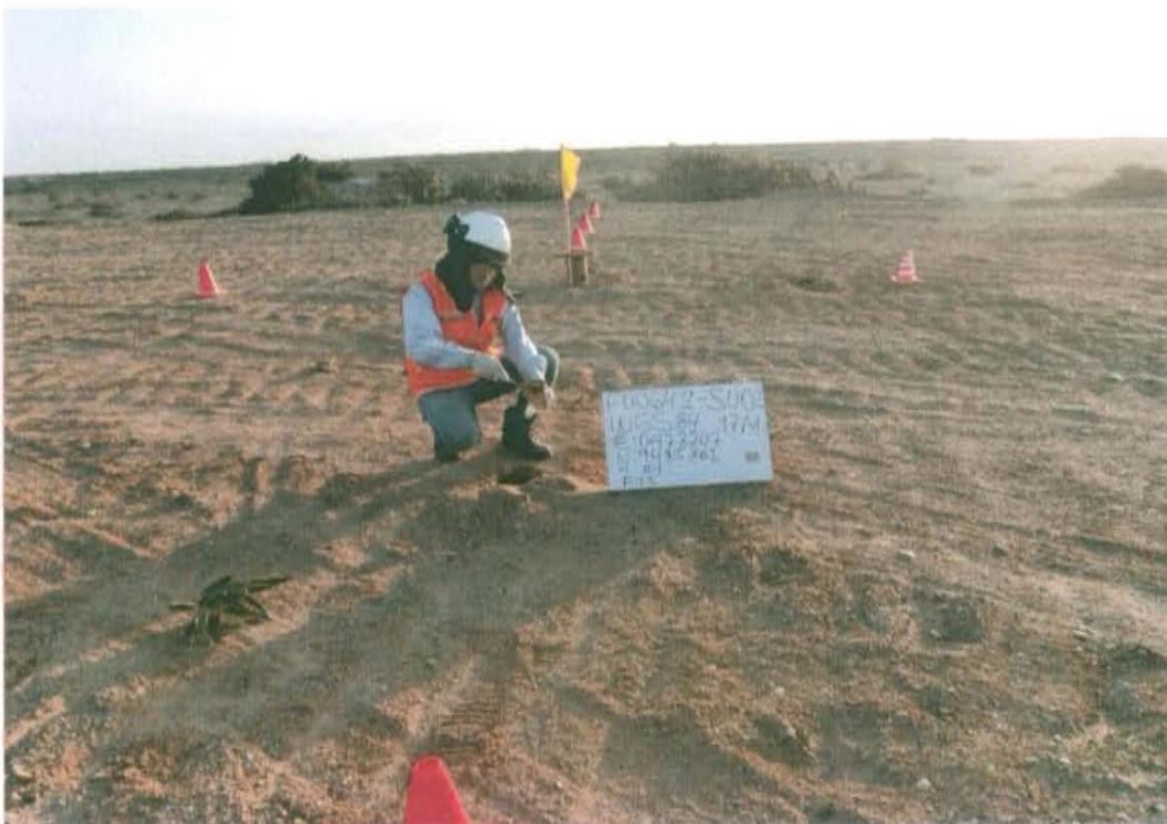
Fotografía N° 3. Toma de muestra de suelo F00642-SU02 a una distancia de 5 m del Pozo T 3114.
