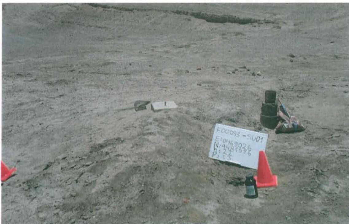
Fotografía N° 3. Toma de muestra de suelo F00093-SU01 a una distancia de 2 m del Pozo T_565.
