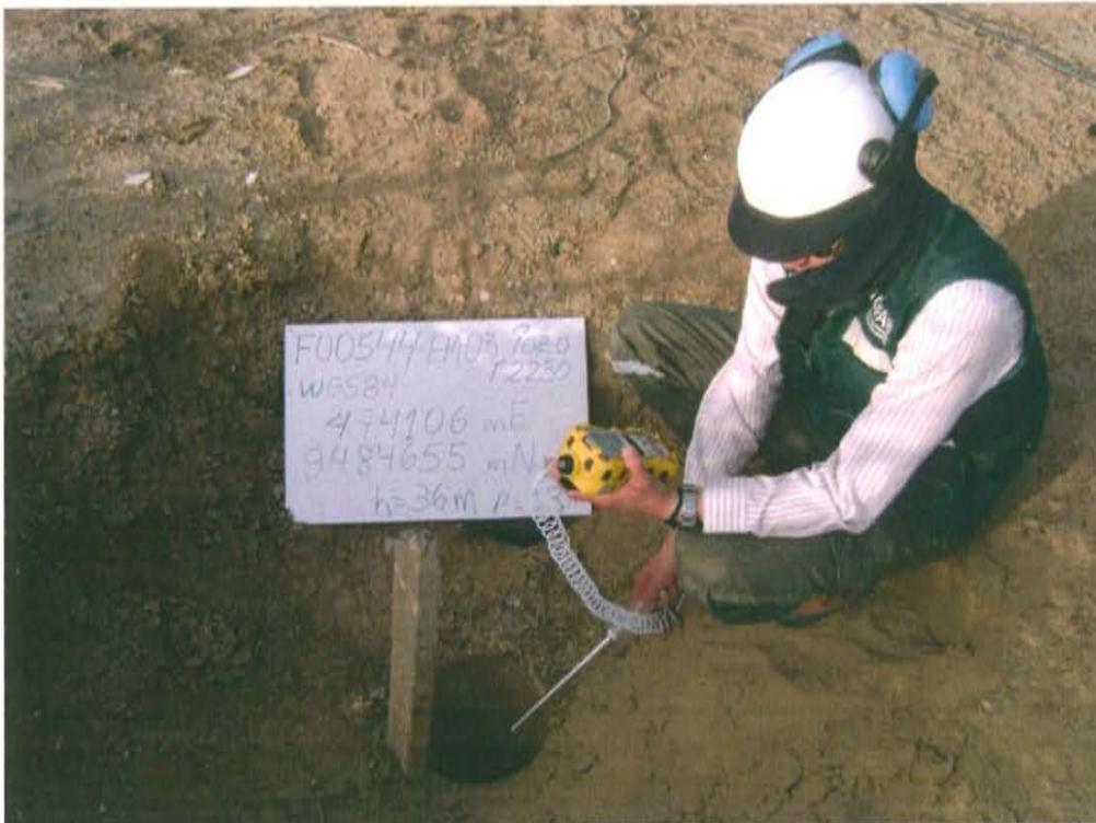
Fotografía N° 4. Medición en el punto F00544-EM03, ubicado en la fuente de emisión en boca del Pozo T2230.
