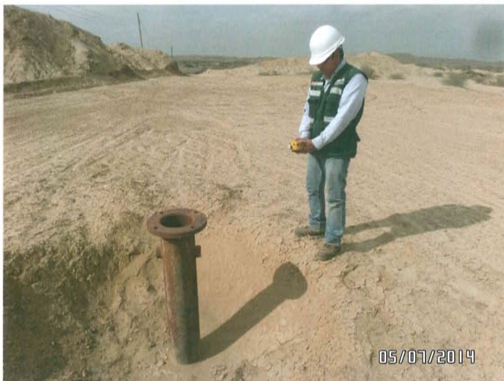
Fotografía N° 3. Medición en el punto F00537-VA01, ubicado a 1 m de distancia en los alrededores del pozo.
