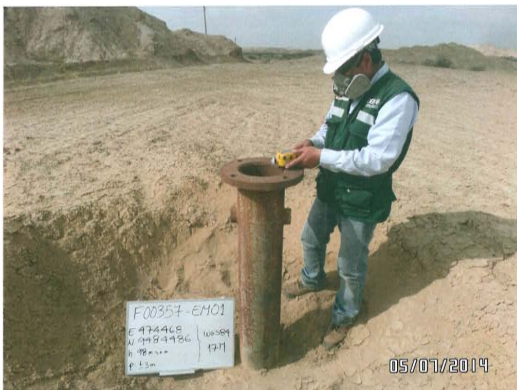
Fotografía N° 4. Medición en el punto F00537-EM01, ubicado en la fuente de emisión en boca del Pozo T1540.
