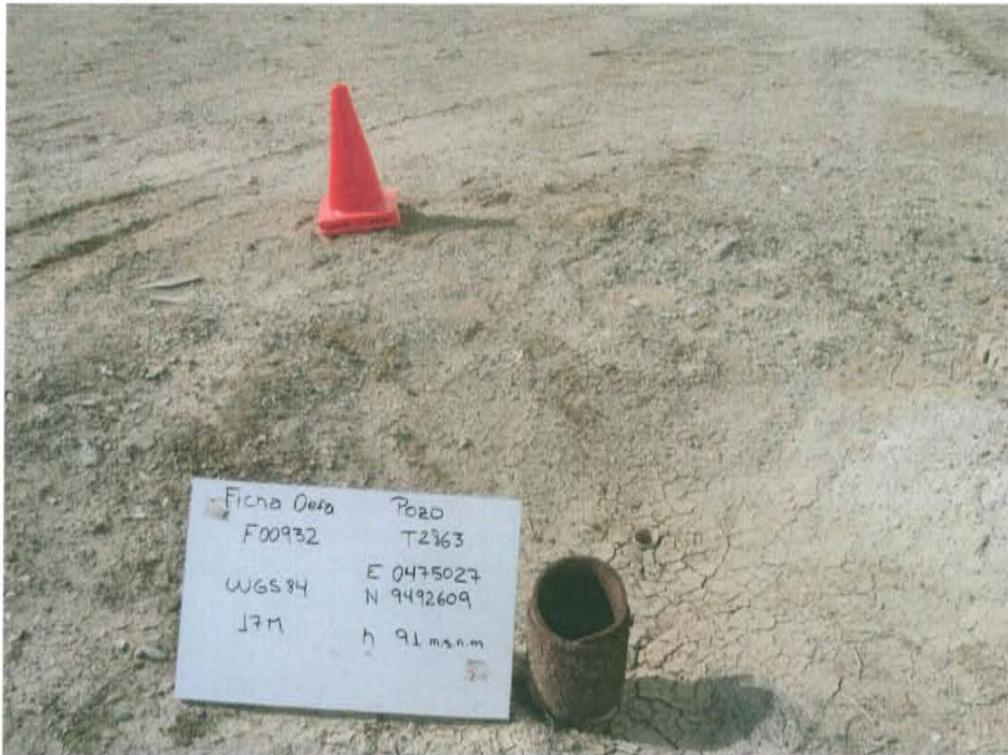
**Fotografía N° 1.** Vista pozo T2863 ubicado en una planicie, se observa el casing posiblemente cortado.
