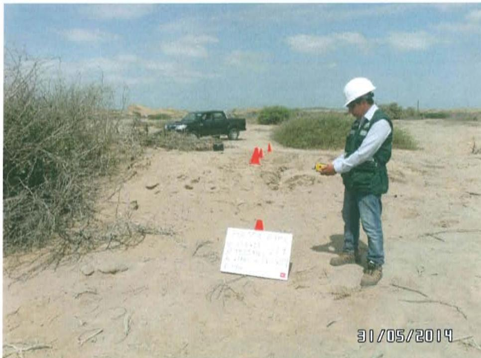
Fotografía N° 4. Medición en el punto F00502-EM02, ubicado a 6 m de la fuente de emisión a sotavento.
