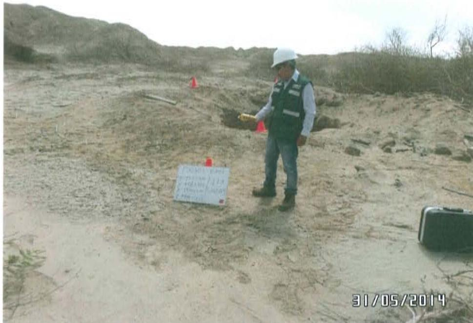
Fotografía N° 3. Medición en el punto F00502-EM01, ubicado a 6 m de la fuente de emisión a barlovento.
