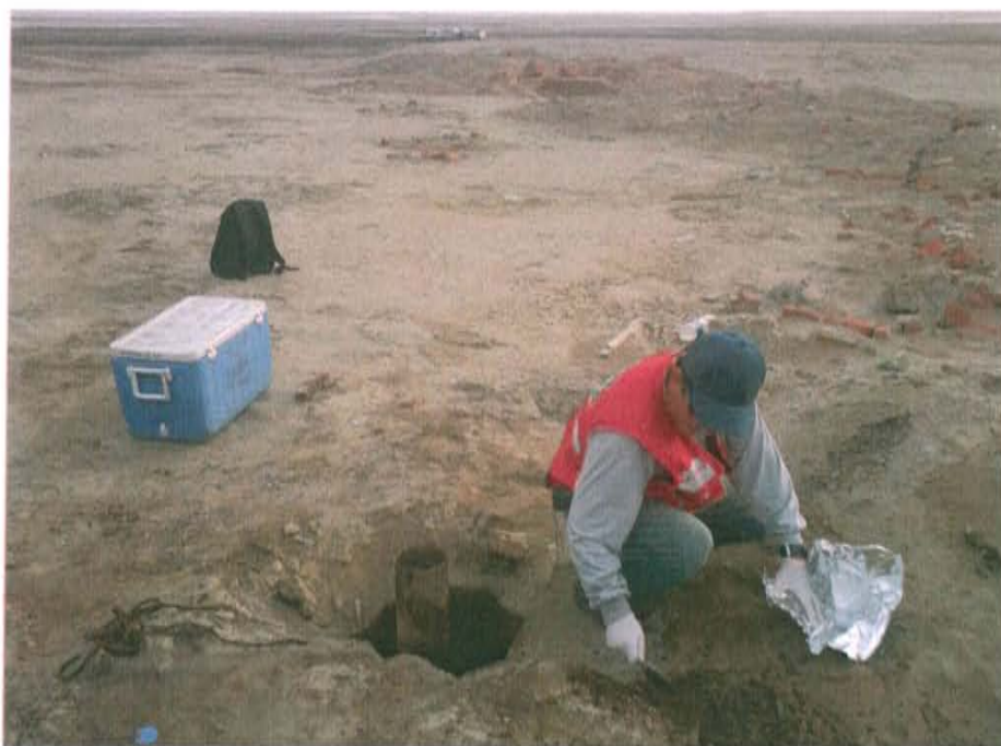
Fotografía N° 2. Se observa la toma de muestra en punto T 491 S1 a una distancia de 1 m del pozo.
