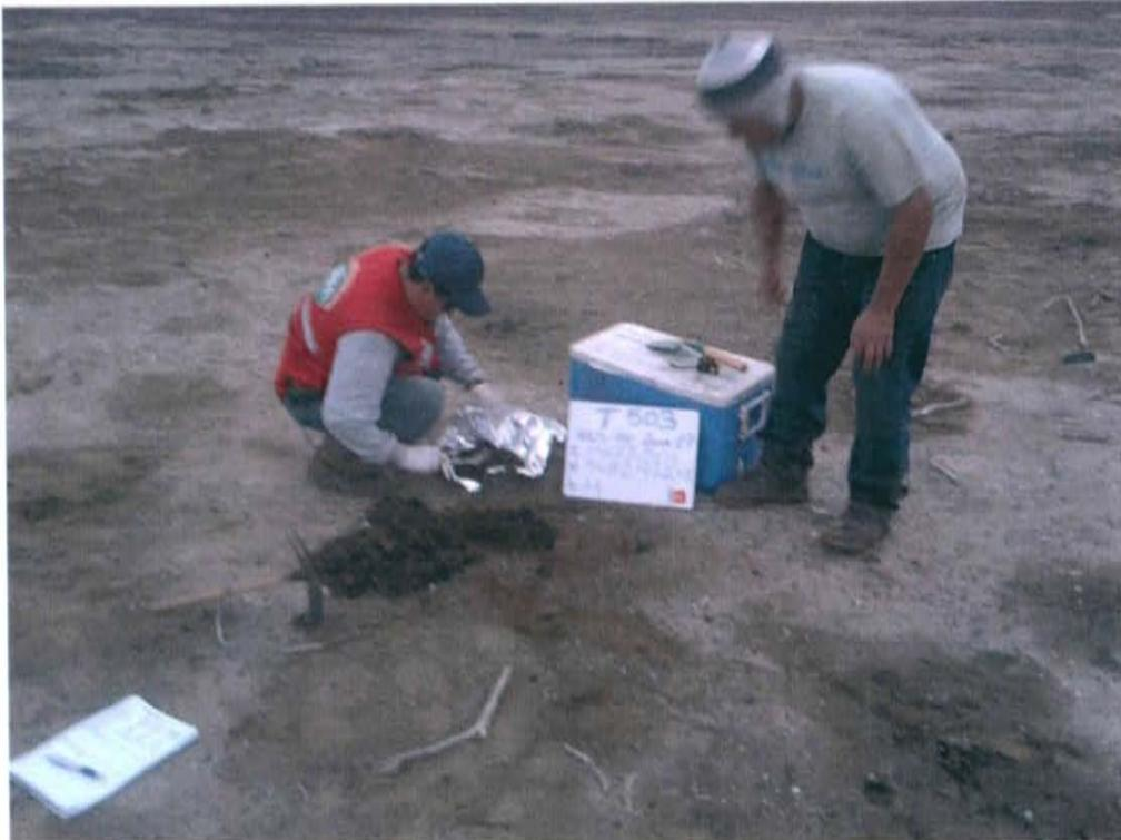
Fotografía N° 3. Toma de muestra de suelo en el puntos de muestreo T 503 S1
