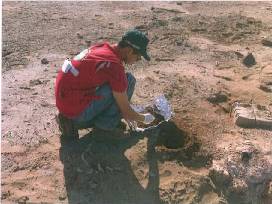
Fotografía N° 1. Pozo T\_408. Se puede apreciar la toma de muestra en el punto T 408 S1 donde se visualiza suelo impregnado con hidrocarburos en el área circundante al pozo.
