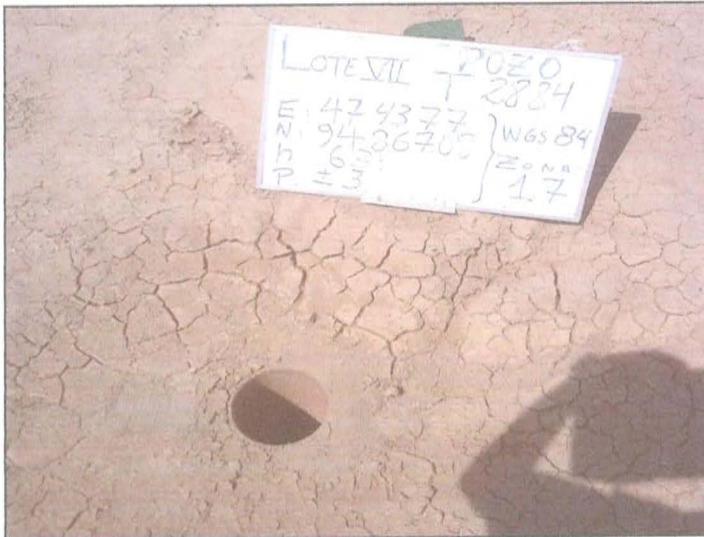
Fotografía N° 1. Vista del pozo petrolero inactivo, se observó casing cortado y corroído a nivel de suelo.
