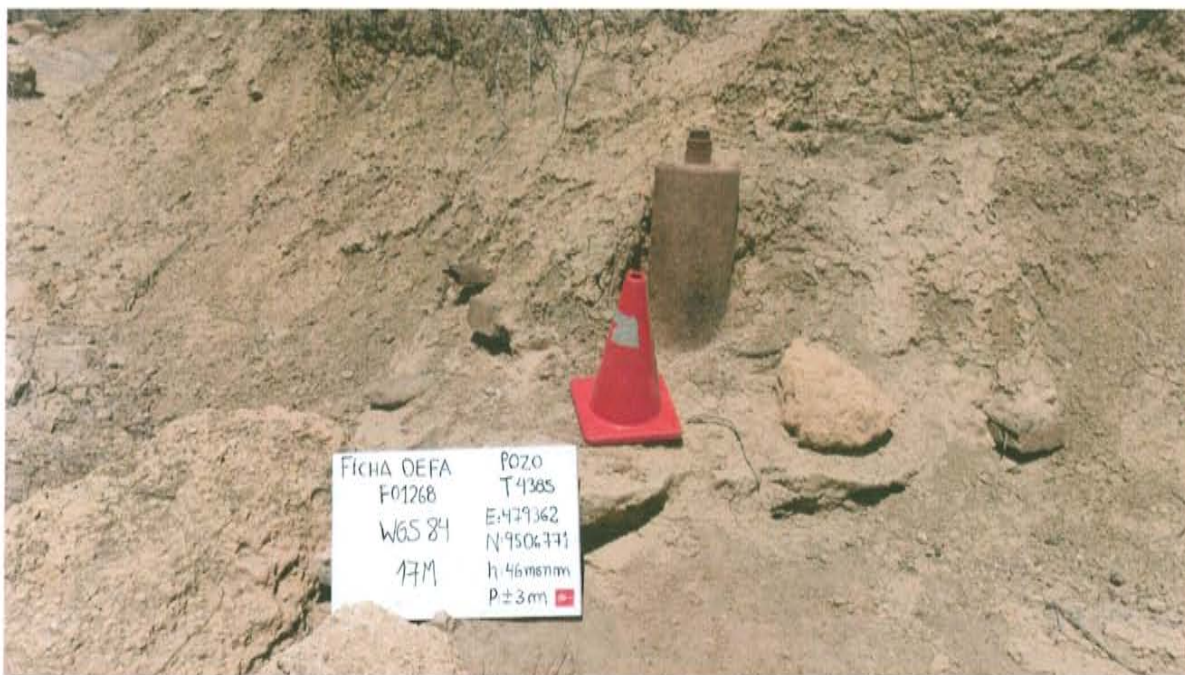
Fotografía N° 1. Se observa el casing corroído que sobresale 0,45 m de la superficie del suelo.
