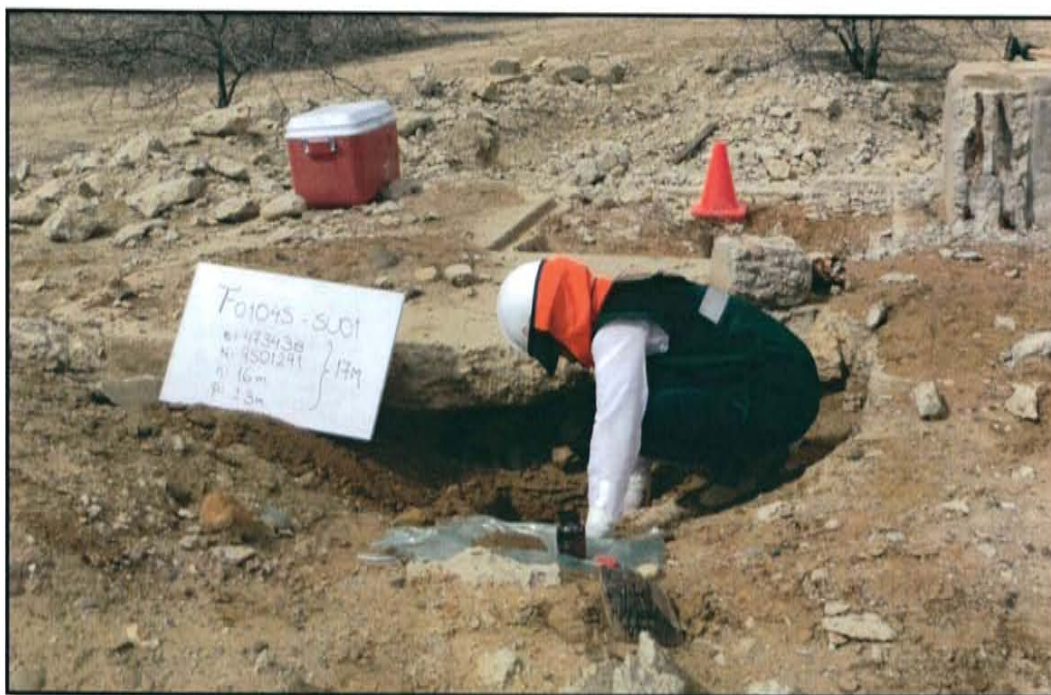
Fotografía N° 3. Toma de muestra en el punto F01045-SU01, ubicado a 2 m de distancia del casing del pozo T3558 a una profundidad de 0,35 m de la superficie del suelo.
