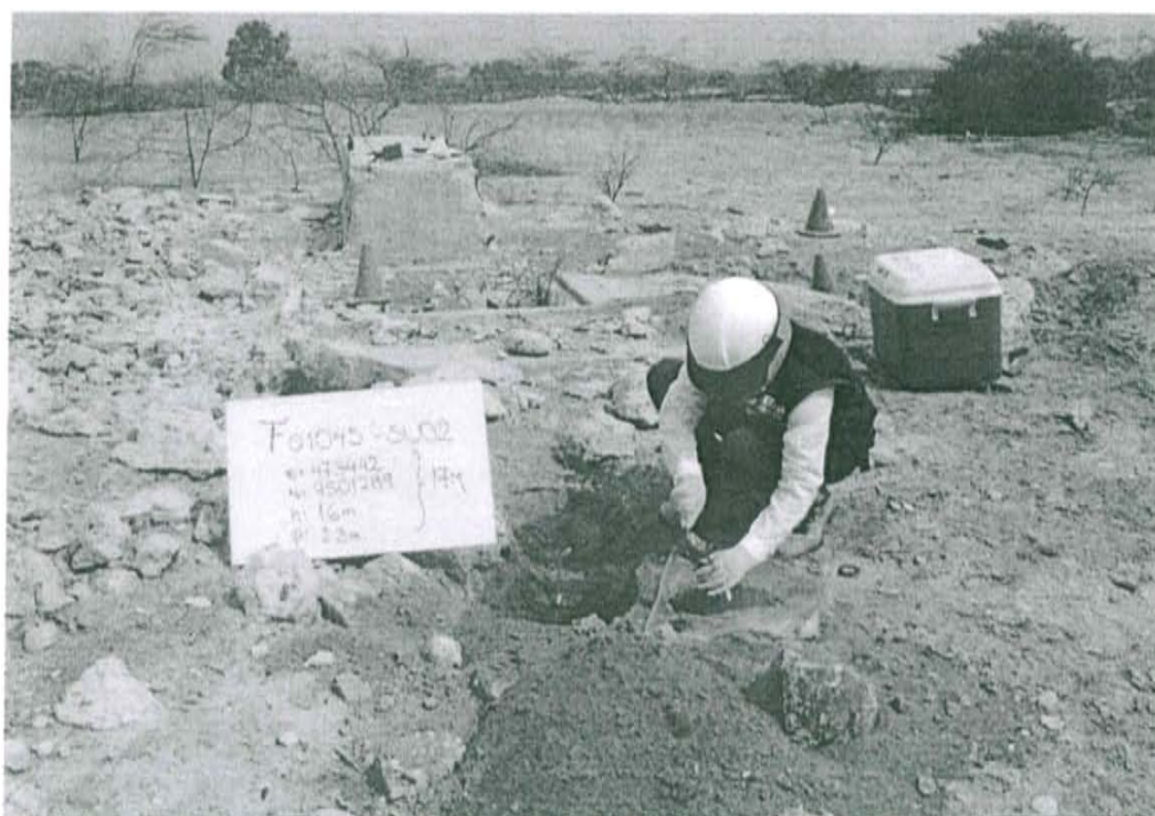
Fotografía N° 2. Toma de muestra en el punto F01045-SU02, ubicado a 3,5 m de distancia del casing del pozo T3558 a una profundidad de 0,35 m de la superficie del suelo.
