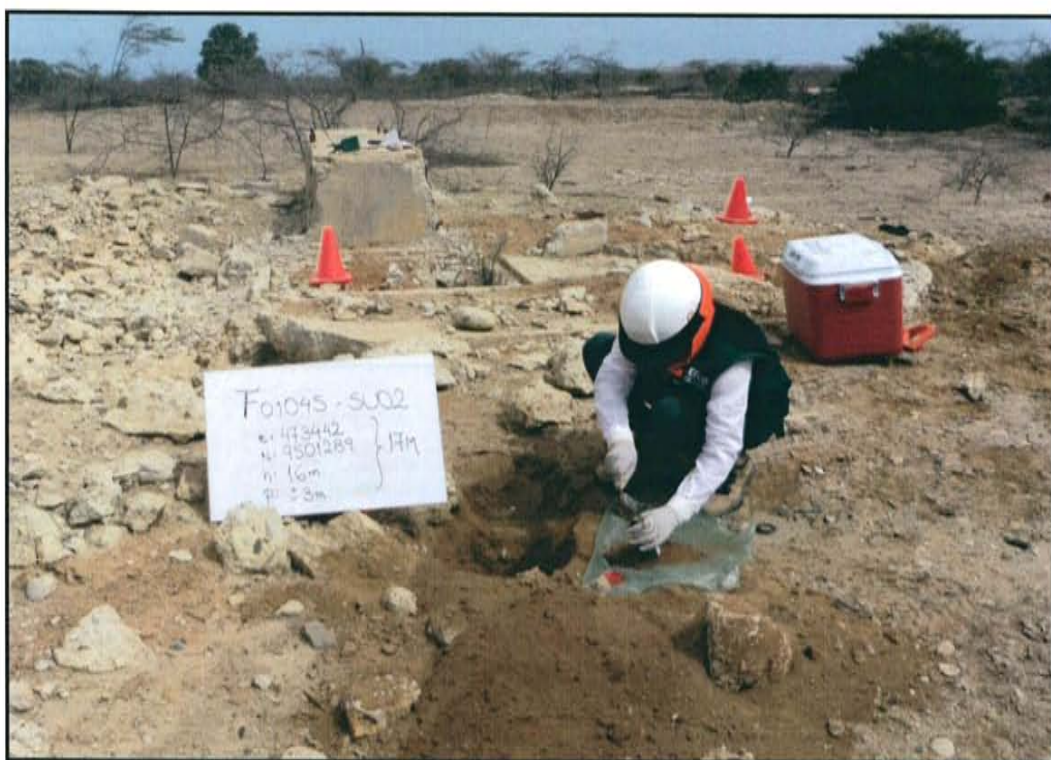
Fotografía N° 4. Toma de muestra en el punto F01045-SU02, ubicado a 3,5 m de distancia del casing del pozo T3558 a una profundidad de 0,35 m de la superficie del suelo.
