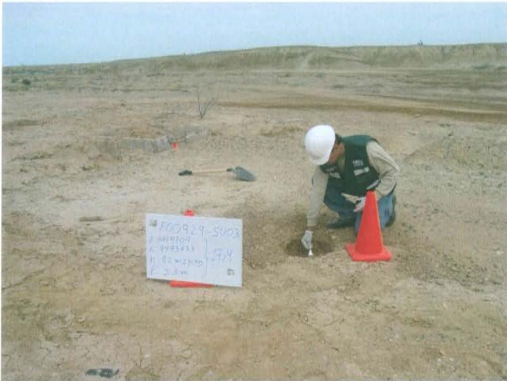
**Fotografía N° 5.** Punto de muestreo F00929-SU03 ubicado a 6 m Noreste del pozo abandonado presenta suelo impregnado de hidrocarburos.
