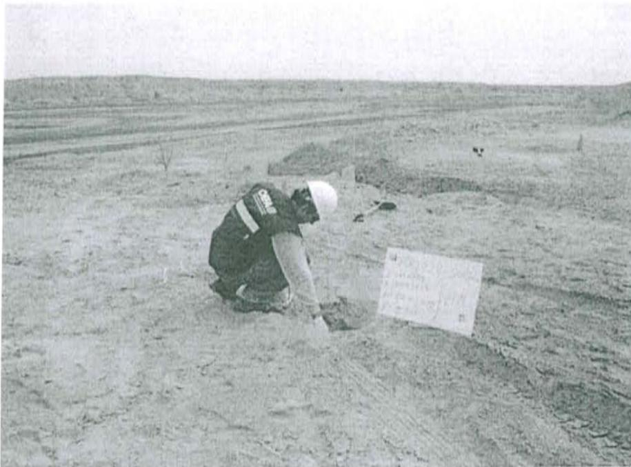
Fotografía N° 2. Toma de muestra de suelo en el punto F00929-SU02, ubicado a 4,2 m aproximadamente del Pozo T5092.
