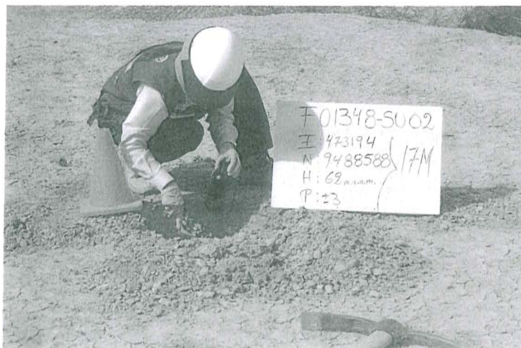
Fotografía N° 2. Toma de muestra en el punto F01348-SU02, ubicado a 4,6 m de distancia del casing del pozo T 1970 a una profundidad de 0,4 m de la superficie del suelo.
