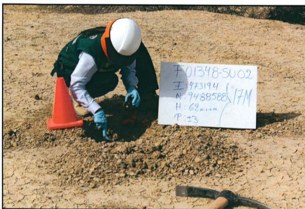
Fotografía N° 4. Toma de muestra en el punto F01348-SU02, ubicado a 4,6 m de distancia del casing del pozo T 1970 a una profundidad de 0,4 m de la superficie del suelo.
