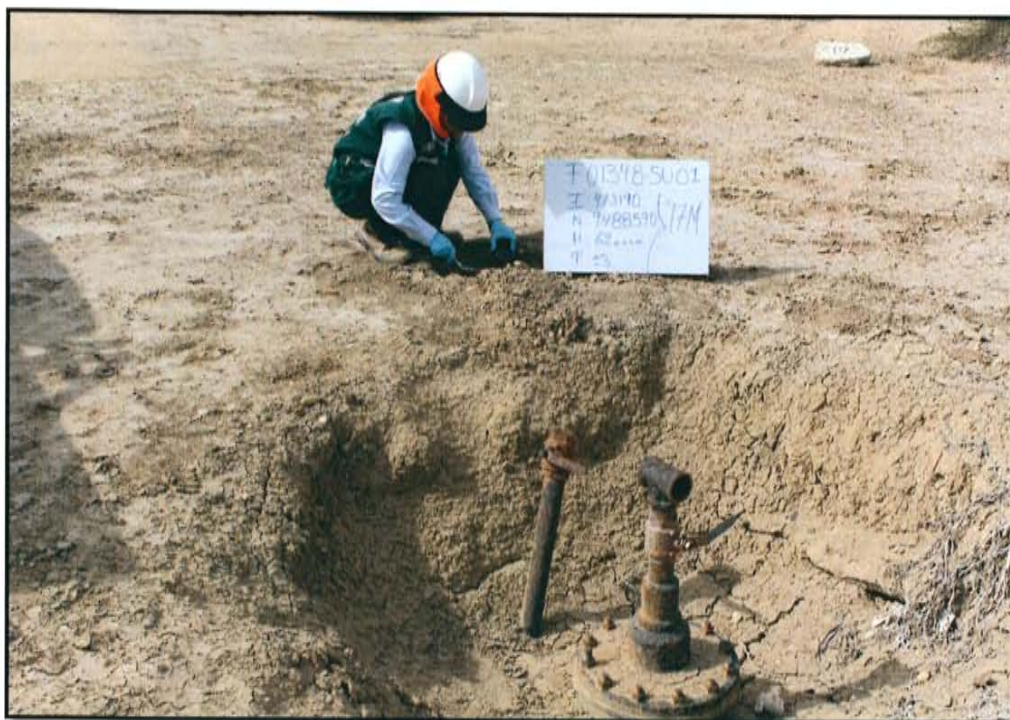
Fotografía N° 3. Toma de muestra en el punto F01348-SU01, ubicado a 2 m de distancia del casing del pozo T 1970 a una profundidad de 0,25 m de la superficie del suelo.
