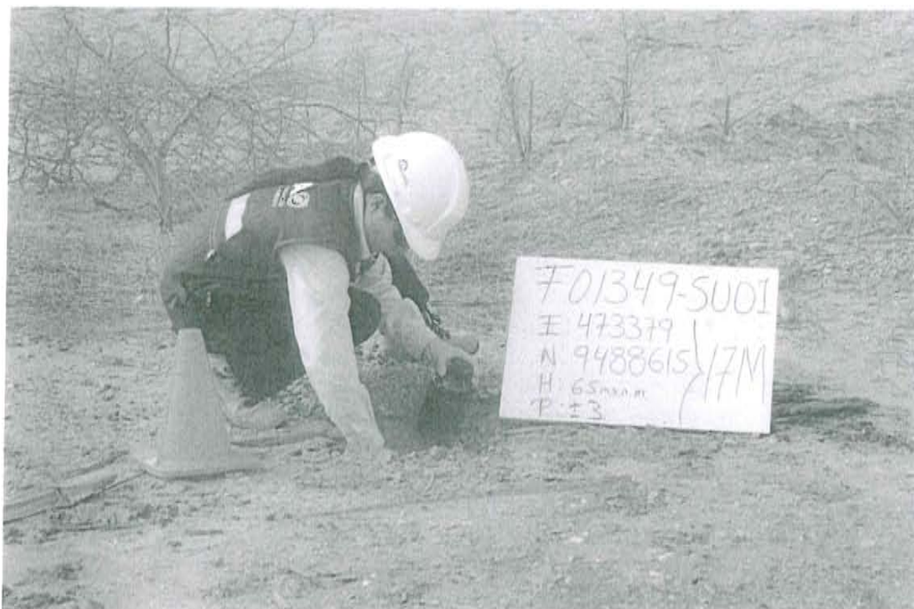
Fotografía N° 1. Toma de muestra en el punto F01349-SU01, ubicado a 2,5 m de distancia del casing del pozo T 2083 a una profundidad de 0,2 m de la superficie del suelo.
