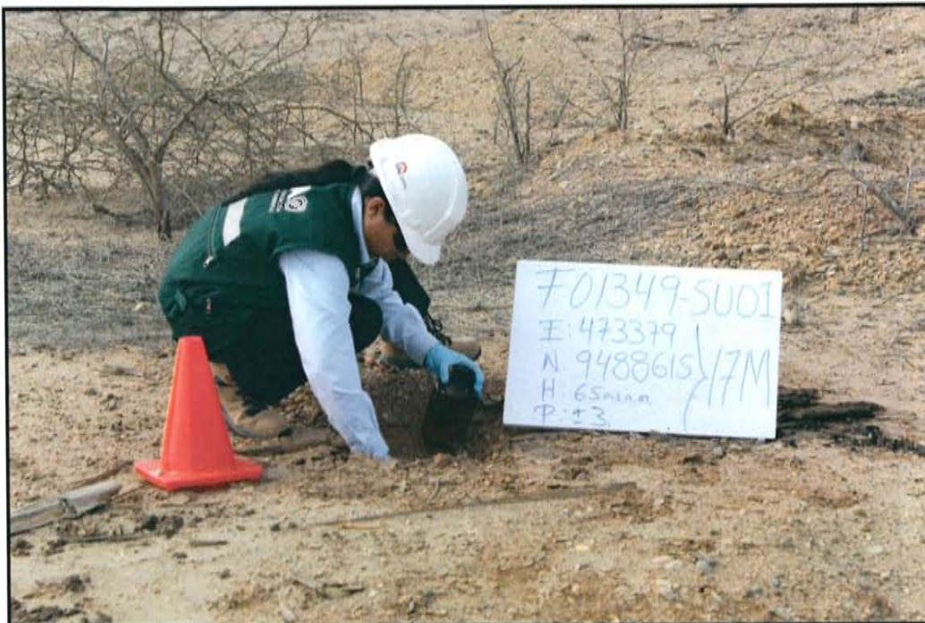
Fotografía N° 3. Toma de muestra en el punto F01349-SU01, ubicado a 2,5 m de distancia del casing del pozo T 2083 a una profundidad de 0,2 m de la superficie del suelo.
