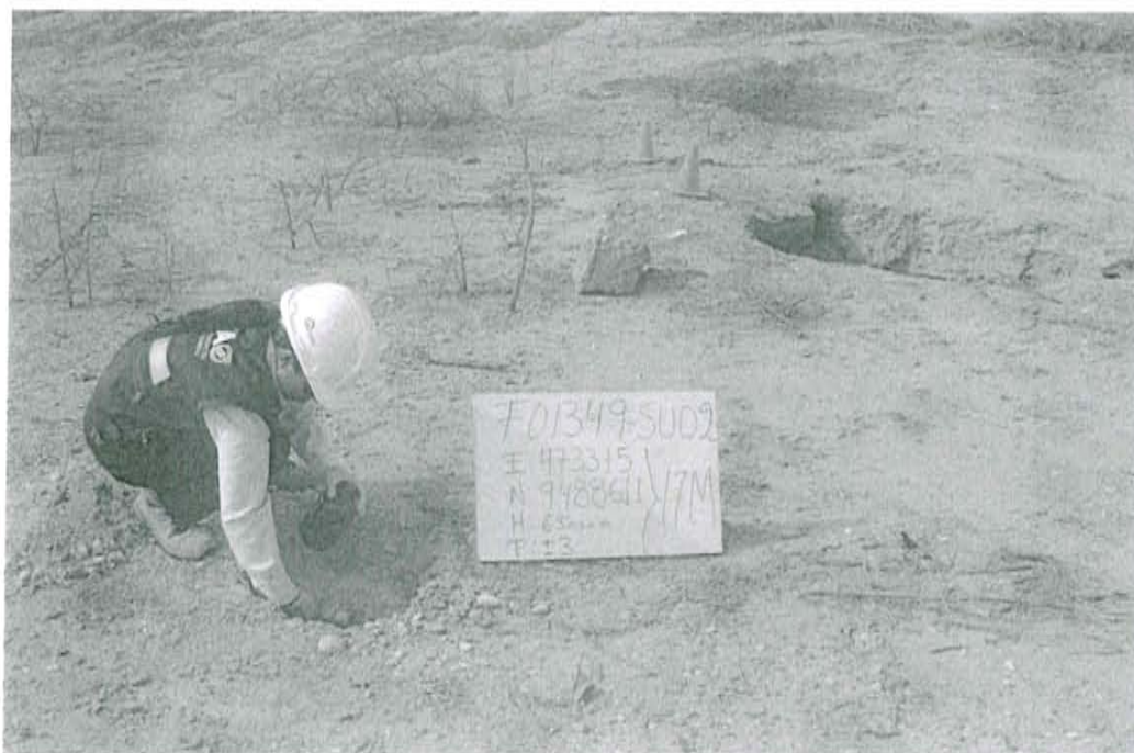
Fotografía N° 2. Toma de muestra en el punto F01349-SU02, ubicado a 4,5 m de distancia del casing del pozo T 2083 a una profundidad de 0,35 m de la superficie del suelo.
