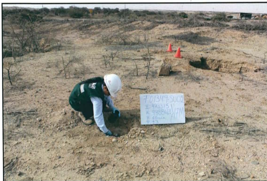
Fotografía N° 4. Toma de muestra en el punto F01349-SU02, ubicado a 4,5 m de distancia del casing del pozo T 2083 a una profundidad de 0,35 m de la superficie del suelo.
