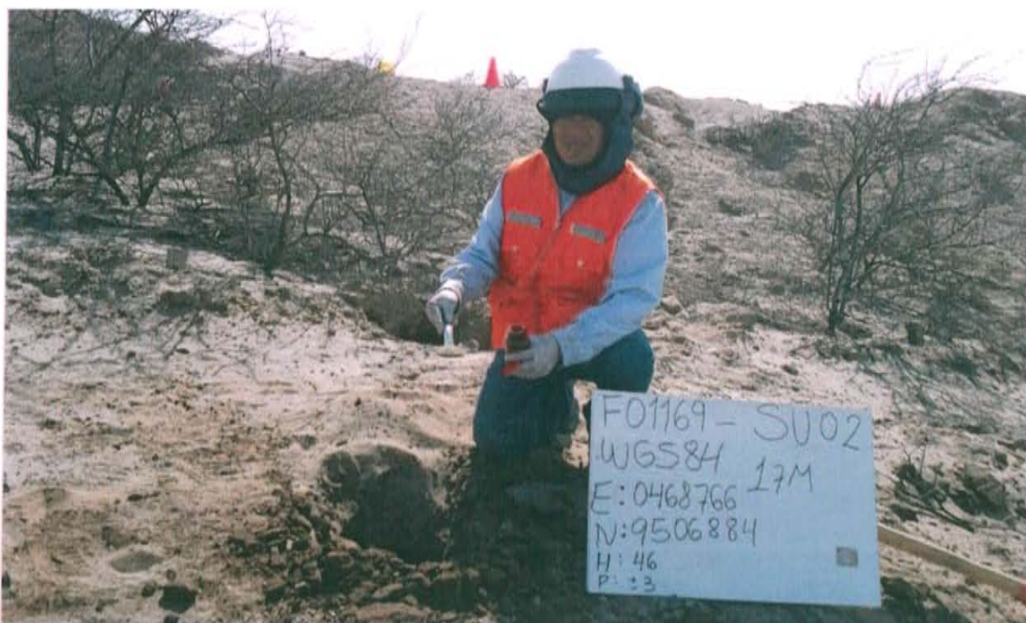
Fotografía N° 6. Toma de muestra de suelo en el punto F01169-SU02, ubicado a 15 m aproximadamente del Pozo L__83.
