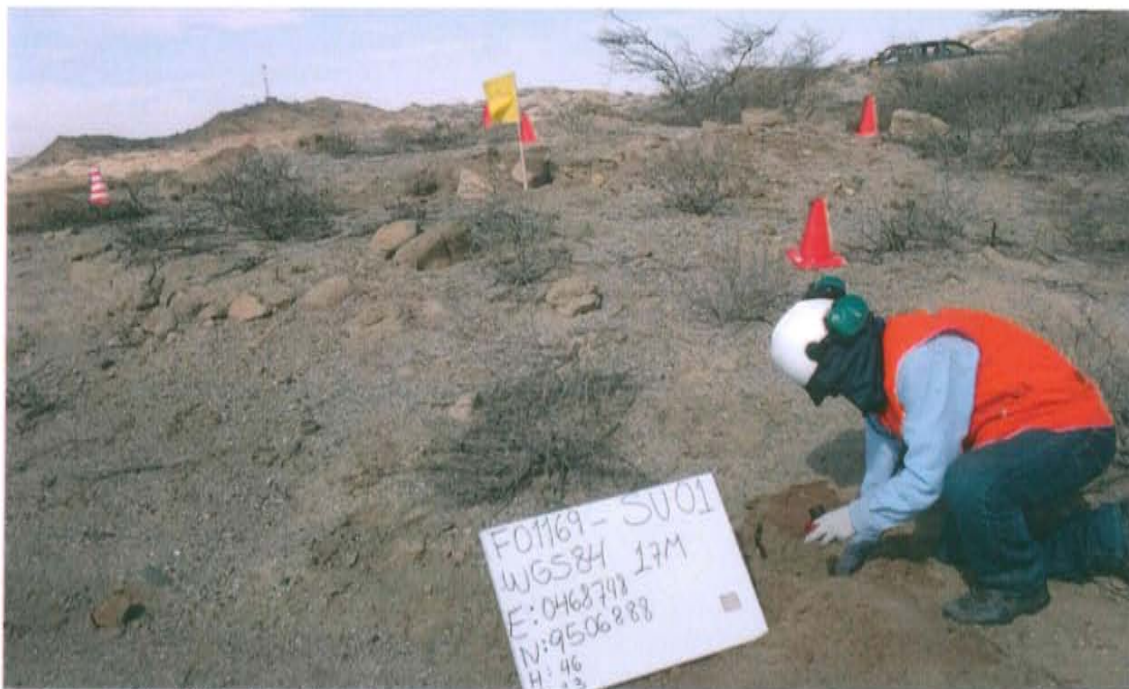
Fotografía N° 5. Toma de muestra de suelo en el punto F01169-SU01, ubicado a 8 m aproximadamente del Pozo L__83.
