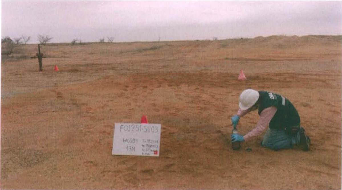
Fotografía N° 5. Toma de muestra de suelo en el punto F01251-SU03, ubicado a 15 m aproximadamente del Pozo T4486.
