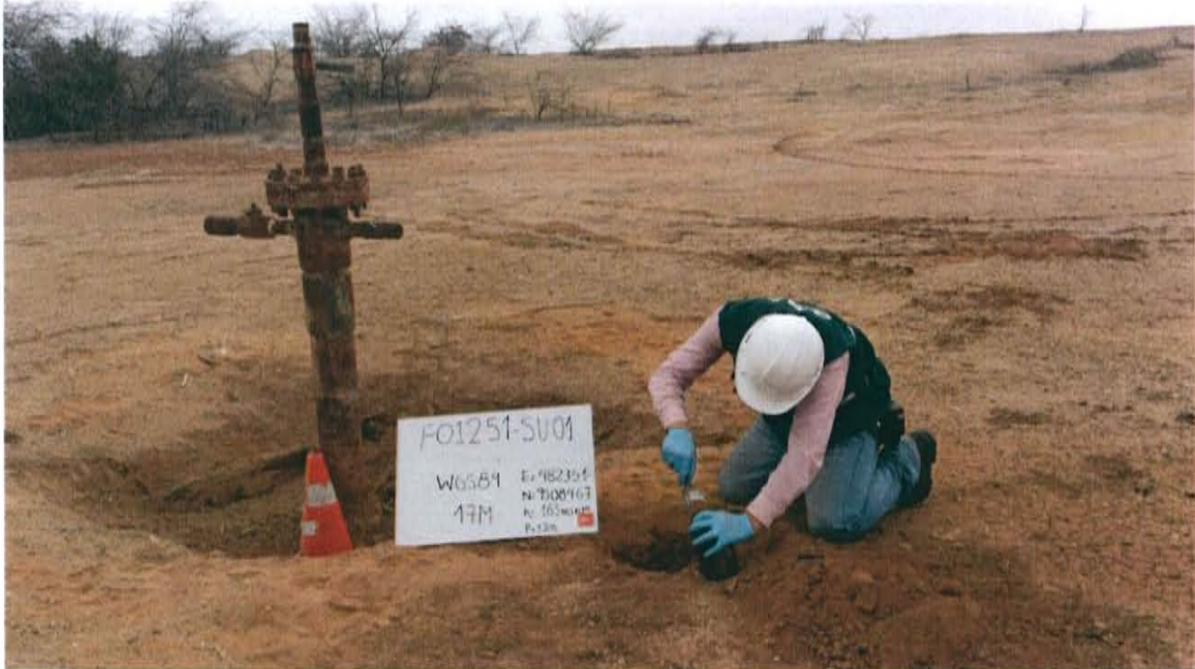
Fotografía N° 3. Toma de muestra de suelo en el punto F01251-SU01, ubicado a 2,00 m aproximadamente del Pozo T4486.
