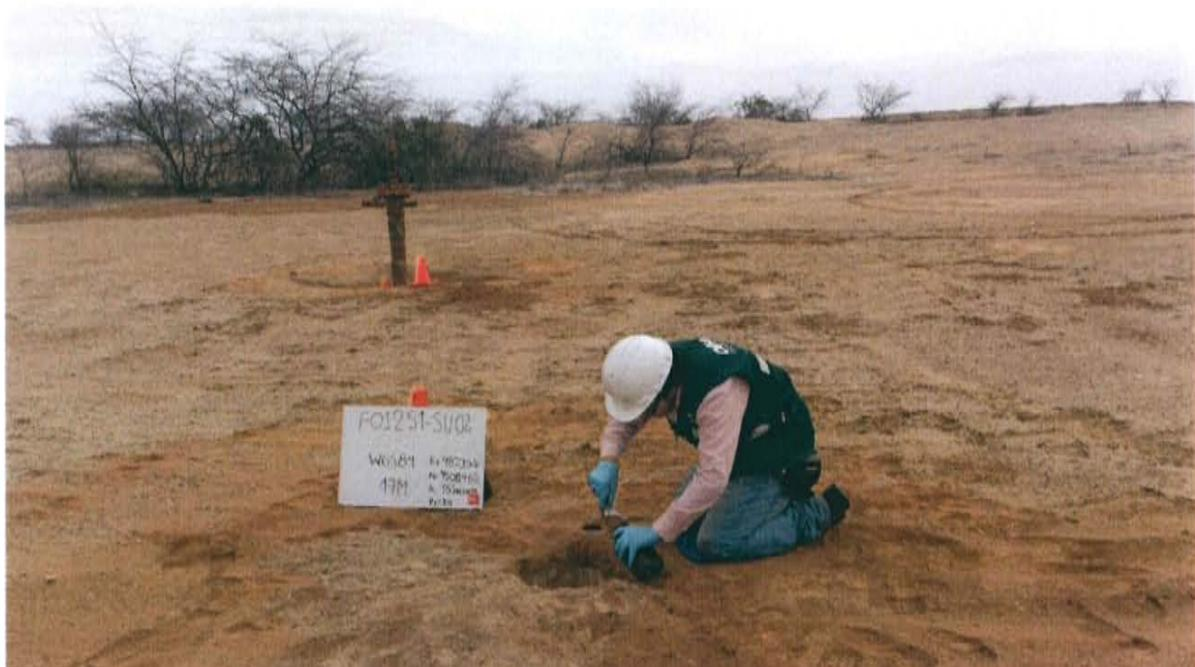
Fotografía N° 4. Toma de muestra de suelo en el punto F01251-SU02, ubicado a 9,00 m aproximadamente del Pozo T4486.
