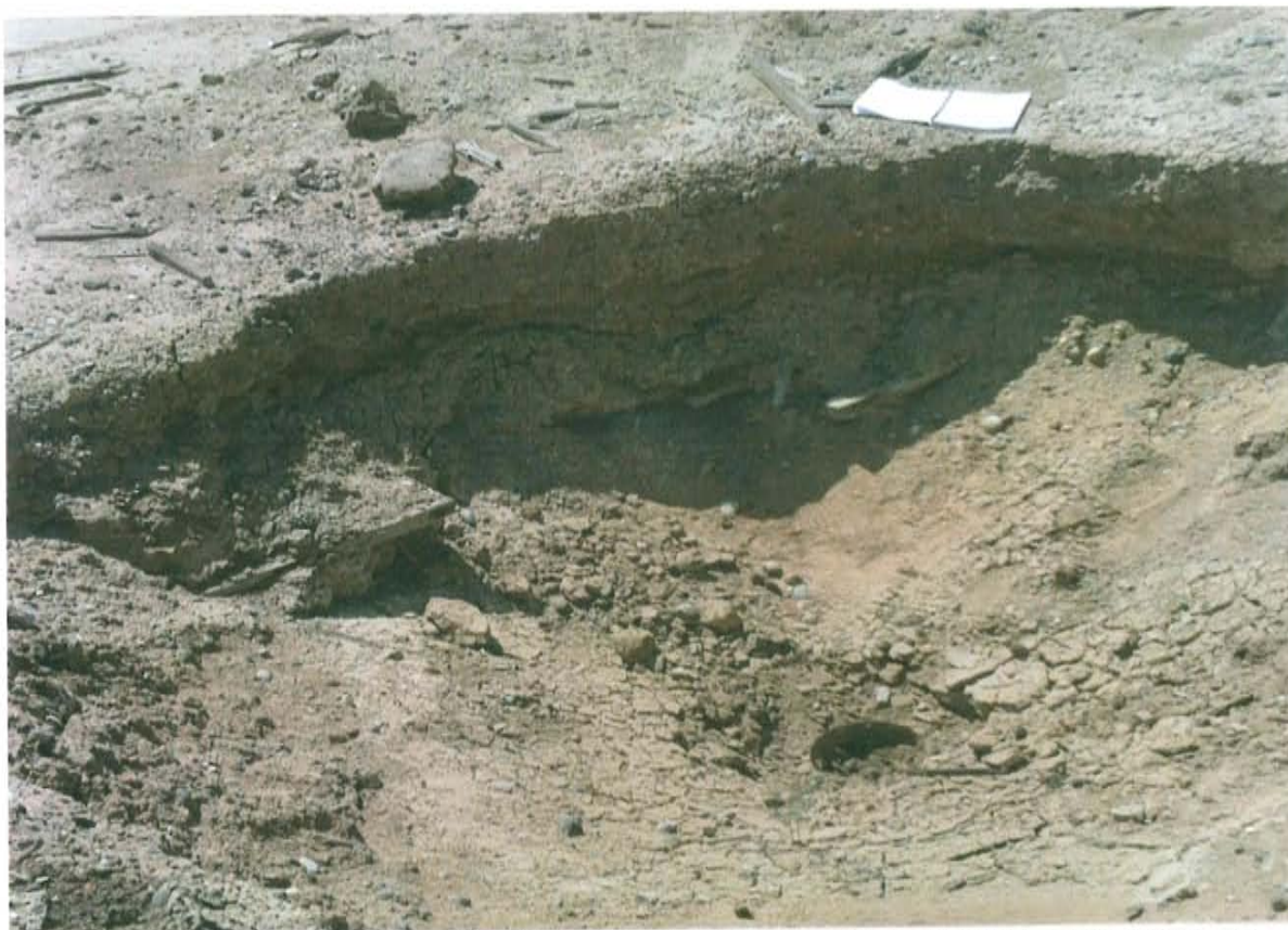
Fotografía N° 1. Pozo con código Ficha OEFA F00561 y código PERUPETRO T1624, se observa el casing corroído y abierto a nivel de la superficie del suelo, ubicado dentro de un hoyo de aproximadamente 1,5 m de profundidad.
