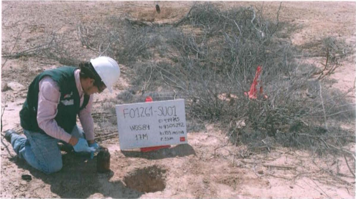
Fotografía N° 3. Toma de muestra de suelo en el punto F01261-SU01, ubicado a 2,5 m aproximadamente del Pozo T4381.
