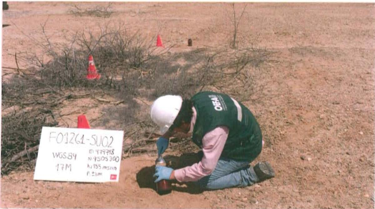
Fotografía N° 4. Toma de muestra de suelo en el punto F01261-SU02, ubicado a 4,5 m aproximadamente del Pozo T4381.
