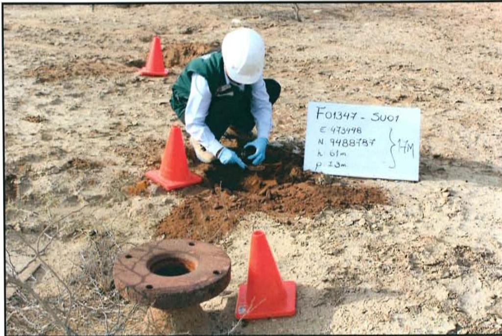
Fotografía N° 3. Toma de muestra en el punto F01347-SU01, ubicado a 1,5 m de distancia del casing del pozo T 2147 a una profundidad de 0,2 m de la superficie del suelo.
