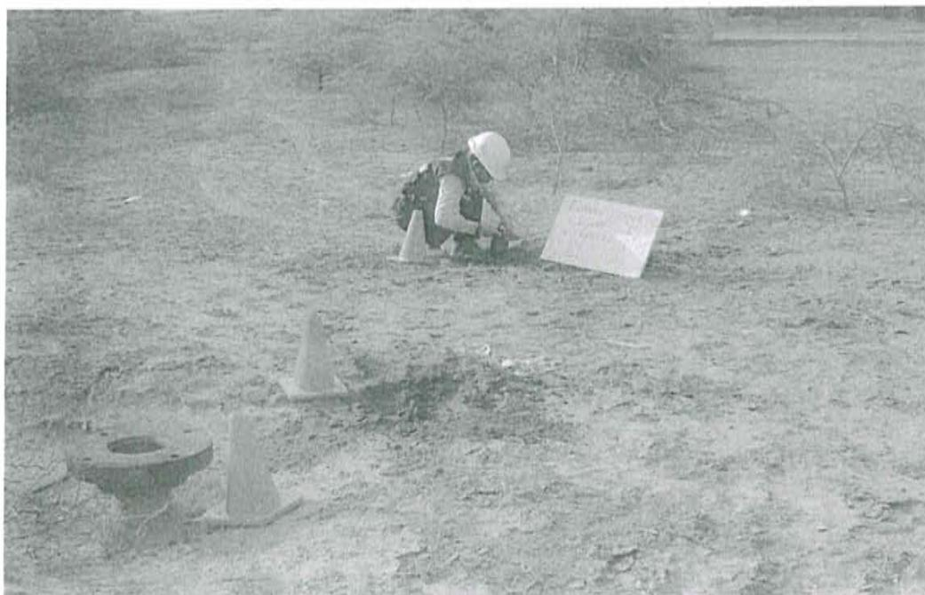
Fotografía N° 2. Toma de muestra en el punto F01347-SU02, ubicado a 4,1 m de distancia del casing del pozo T 2147 a una profundidad de 0,4 m de la superficie del suelo.
