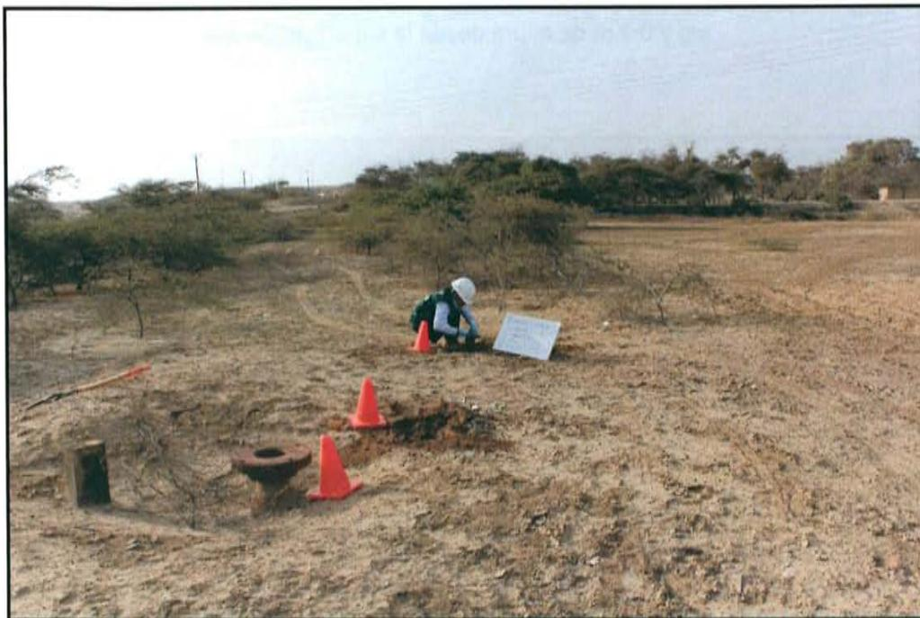
Fotografía N° 4. Toma de muestra en el punto F01347-SU02, ubicado a 4,1 m de distancia del casing del pozo T 2147 a una profundidad de 0,4 m de la superficie del suelo.
