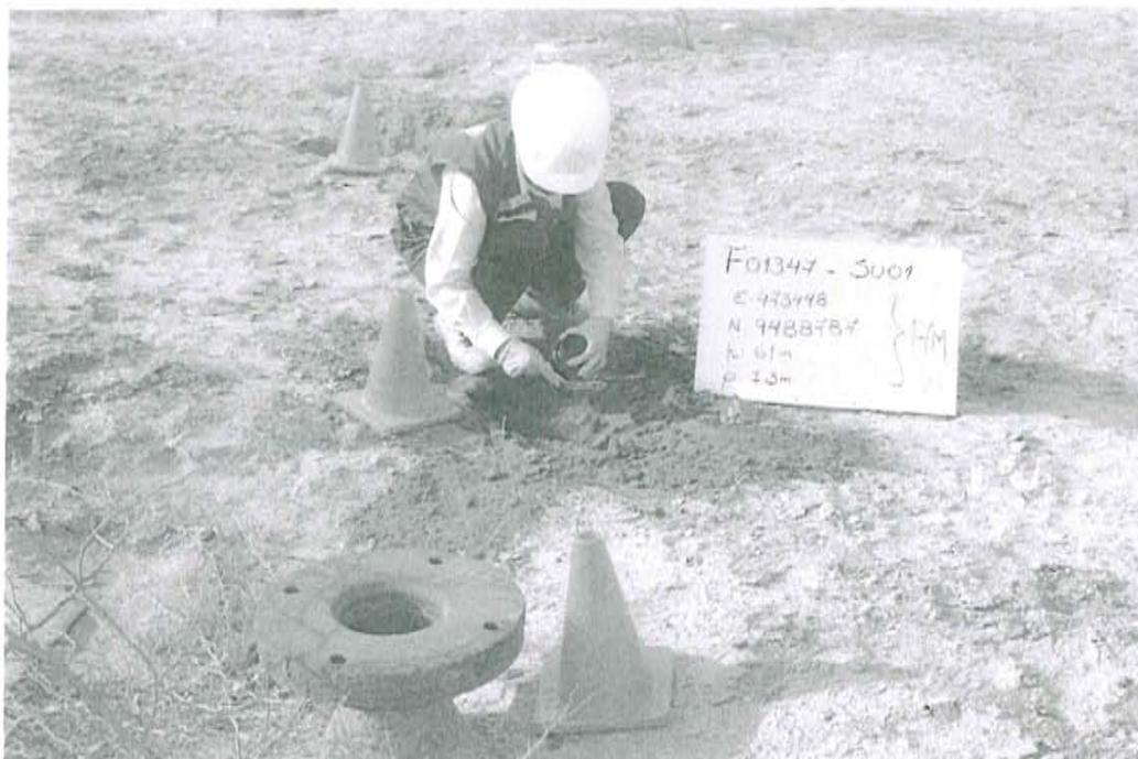
Fotografía N° 1. Toma de muestra en el punto F01347-SU01, ubicado a 1,5 m de distancia del casing del pozo T 2147 a una profundidad de 0,2 m de la superficie del suelo.
