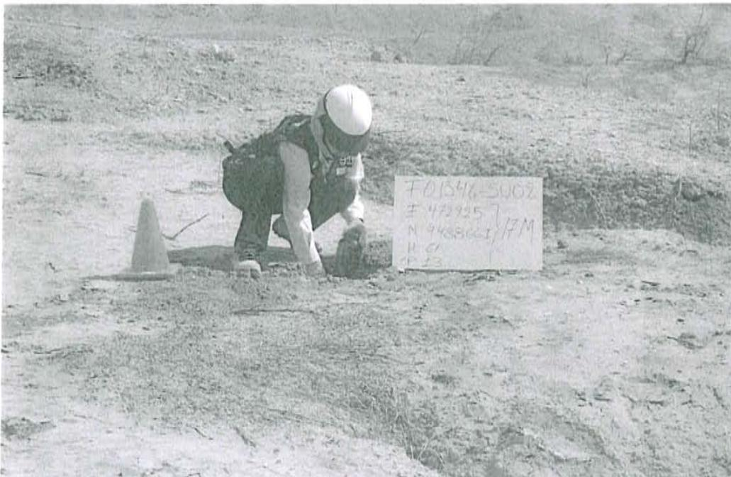
Fotografía N° 2. Toma de muestra en el punto F01346-SU02, ubicado a 4,2 m de distancia del casing del pozo T 2108 a una profundidad de 0,35 m de la superficie del suelo.
