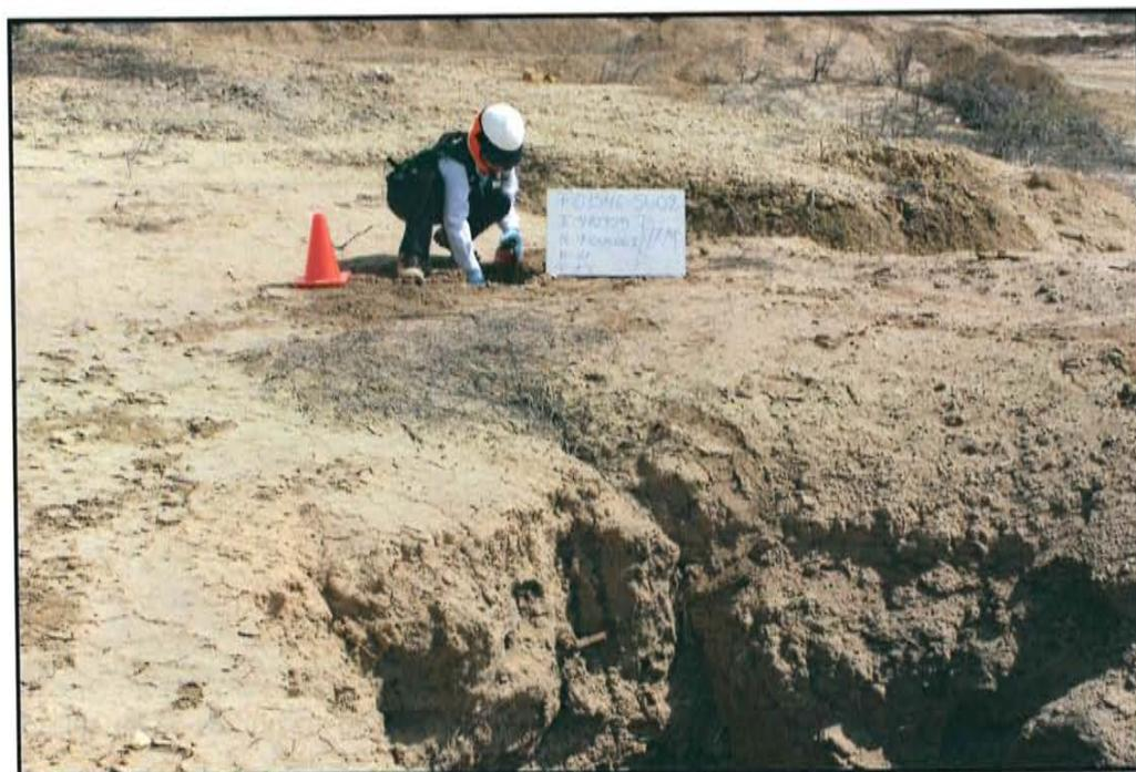
Fotografía N° 4. Toma de muestra en el punto F01346-SU02, ubicado a 4,2 m de distancia del casing del pozo T 2108 a una profundidad de 0,35 m de la superficie del suelo.
