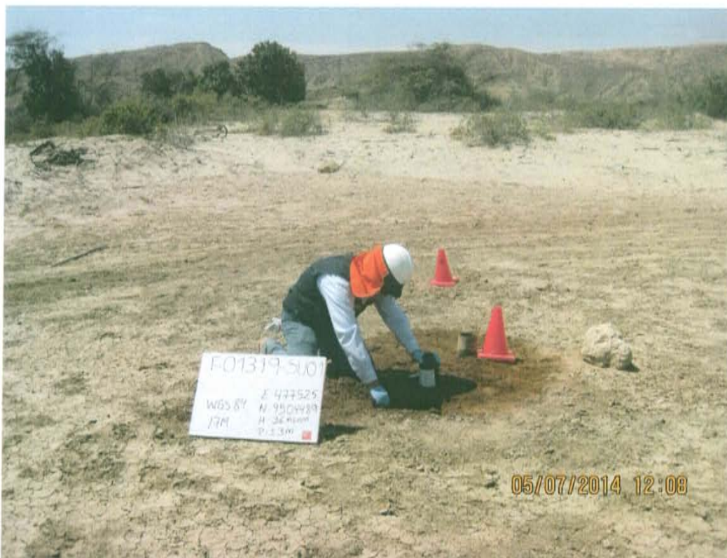
Fotografía N° 3. Toma de muestra de suelo en el punto F01319-SU01, ubicado a 0,8 m aproximadamente al oeste del Pozo T5530.
