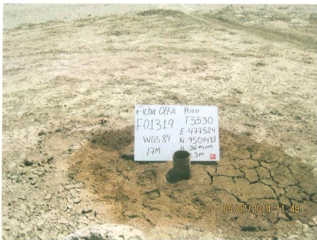
Fotografía N° 1. Identificación del pozo inactivo con código PERUPETRO T5530. Presenta casing abierto que sobresale 0,18 m sobre la superficie del suelo.
