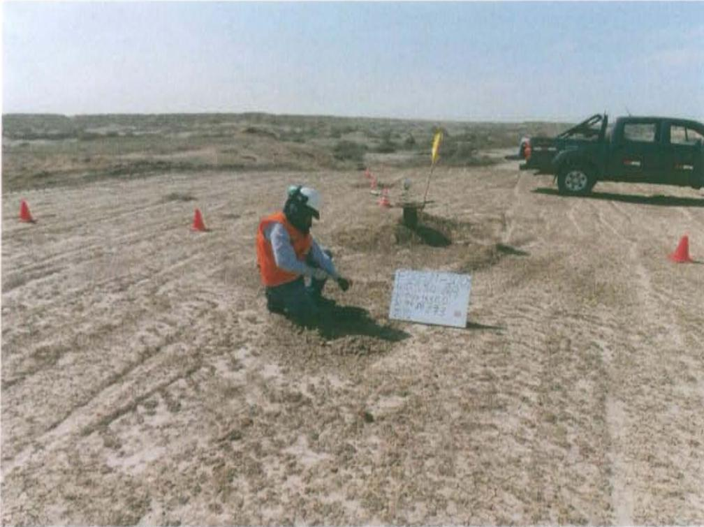
Fotografía N° 3. Toma de muestra de suelo en el punto F00581-SU01, ubicado aproximadamente a 3 m al sur del Pozo T2640.
