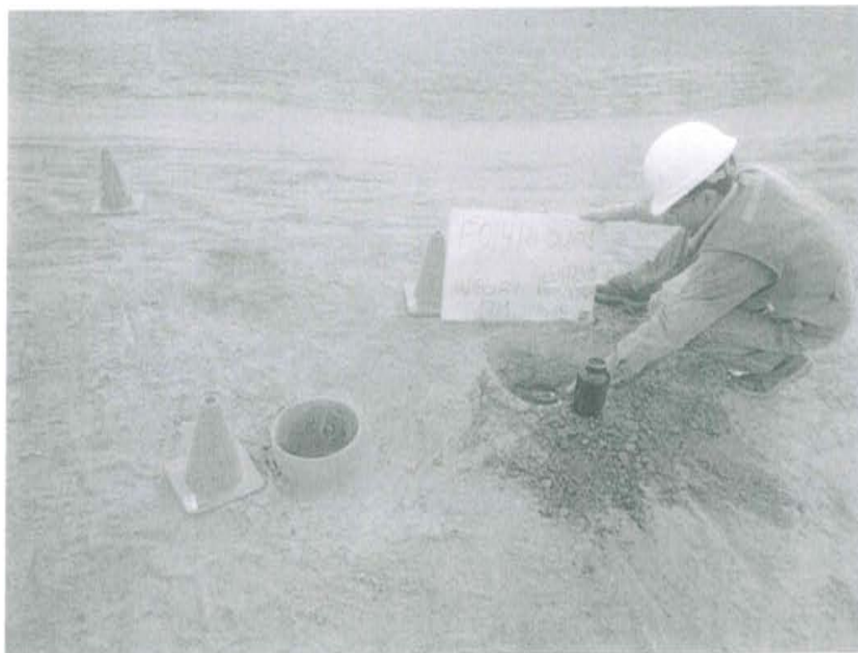
Fotografía N° 1. Toma de muestra de suelo en el punto F01416-SU01, ubicado a 1 m aproximadamente del Pozo T2079.
