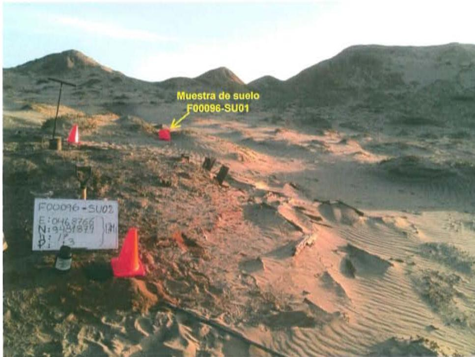
Fotografía N° 3. Toma de muestra de suelo en el punto F00096-SU02, ubicado a 4 m aproximadamente del Pozo T\_645.
